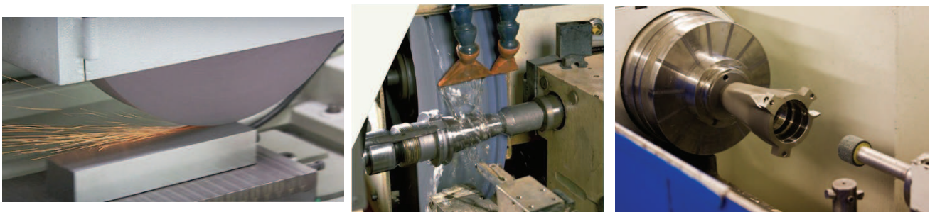
Figure 7 : Opérations de rectification (source NORTON, PFERD)
