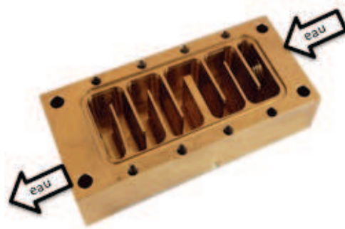
Figure 66 : Echangeur thermique intégré au porte-échantillon
