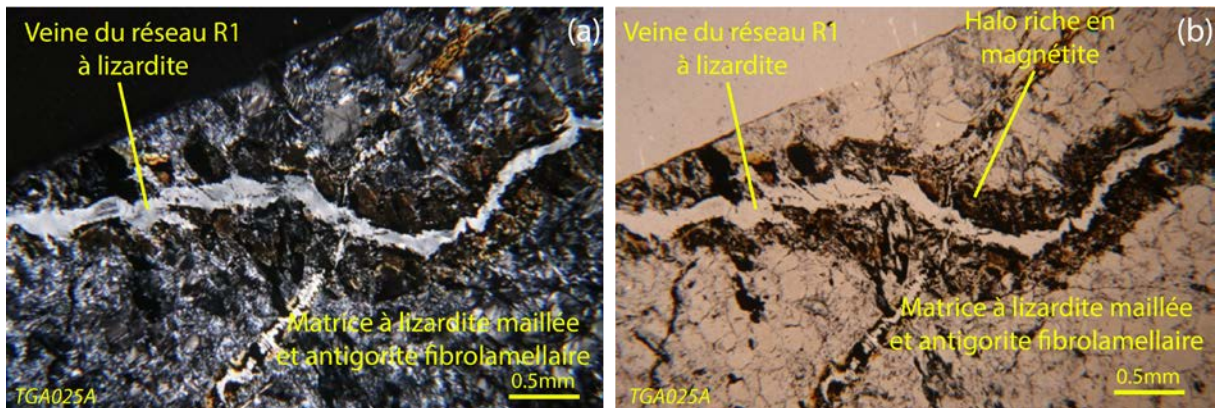
Fig. IV-16 : microphotographies (a) en LPA et (b) en LPNA, des veines du réseau R1 soulignées par des halos de magnétite.
