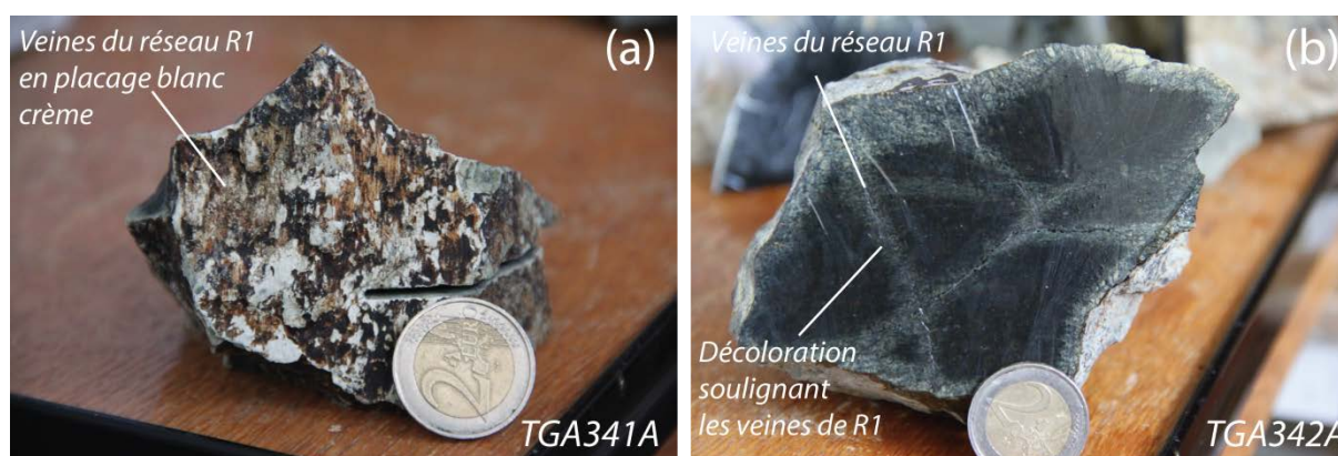
Fig. VI-3 : photographies des faciès de péridotites prélevées dans la carrière de Kerguelmès. (a) péridotite serpentinisée avec placage blanc crème du réseau R1 correspondant à la fracturation principale de la roche. (b) péridotite serpentinisée à cœur sombre, recoupé par des veines du réseau R1 soulignées par une décoloration de la roche. Notons que ces veines apparaissent souvent lessivées de leur contenu.
