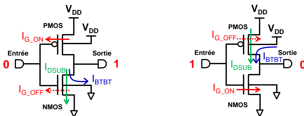
Figure 1-32 : Principaux courants de fuite d'un inverseur CMOS en fonction de l'état logique du signal d'entrée et du signal de sortie
