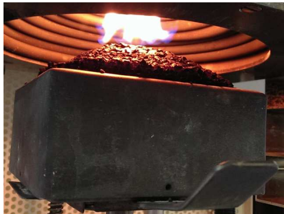
Figure 56 : Photographie du comportement du matériau EPDM lors d'un essai
