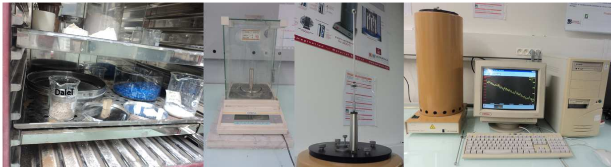
Figure IV-25 : Mesure de la capacité calorifique : mise à l'étuve de l'échantillon broyé, pesage, introduction dans la cellule et traitement de données
