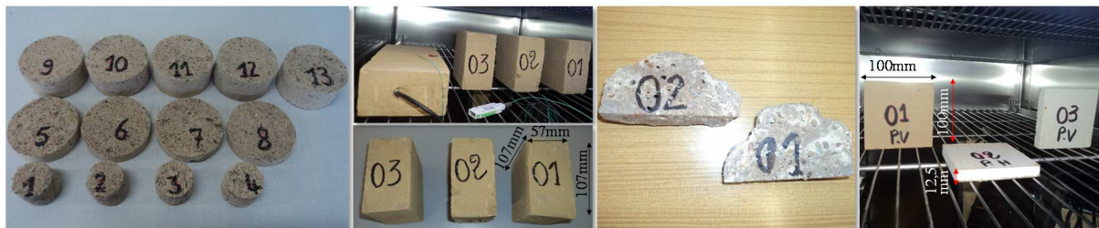
Figure IV-2 : Echantillons des matériaux béton de bois, terre crue, travertin et plaque de plâtre
