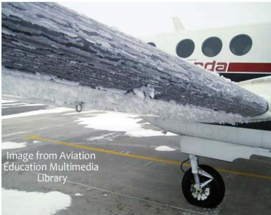
FIGURE 1.2 – Image d'un avion dont les ailes sont recouvertes de glace suite à la nucléation de l'eau surfondue.[5]
