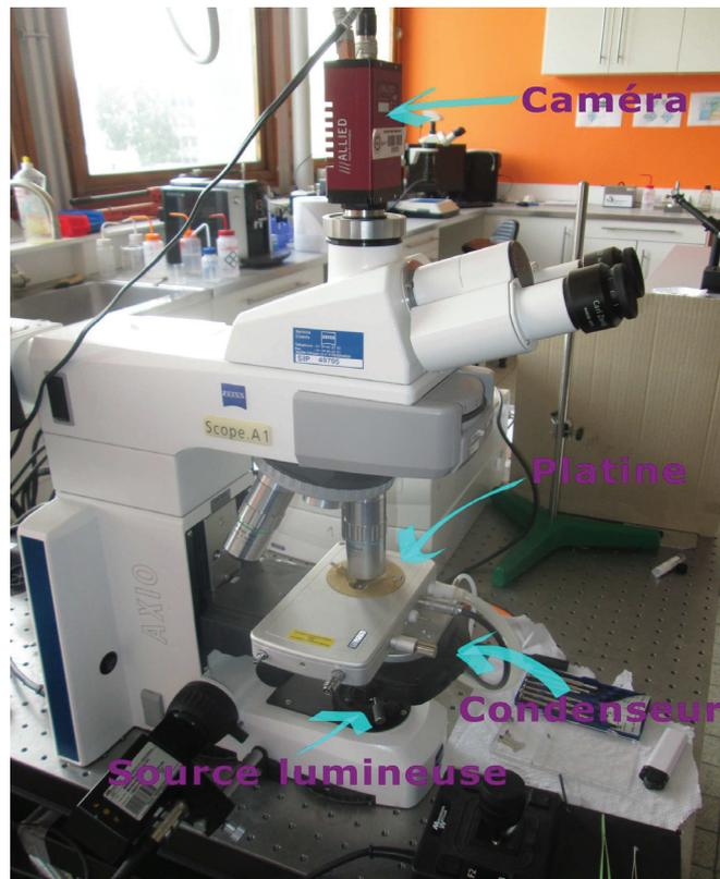
FIGURE 3.3 – Image du microscope et de la platine Linkam.
