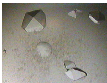
Figure 15. Cristaux tétraogonaux de hBChE obtenues en goutte suspendue dans du tampon MES 0.1 M pH 6.5, 2.1 M (NH 4 ) 2 SO 4 .
