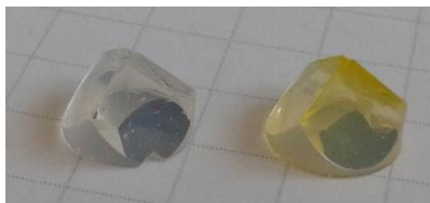
Figure 5.26 : photographie d'un rétroreflécteur de formulation 26, avant (à gauche) et après (à droite) des expositions successives à des solutions de 2-NP dans le mélange sang de cheval/sérum physiologique tamponné.
