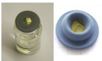
Figure 5.23 : Photographie d'un flacon contenant une solution tamponnée de 2-NP fermé par un septum avec un xérogel rétroreflécteur et zoom sur le septum et le rétroreflécteur. La pointe du rétroreflécteur est dirigée vers la solution.
