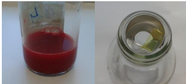
Figure 4.28 : Photographies d'un flacon contenant le sang de cheval dilué dans un milieu de culture (à gauche) et d'un xérogel dans un support en aluminium qui est inséré dans le goulot du flacon (à droite).
