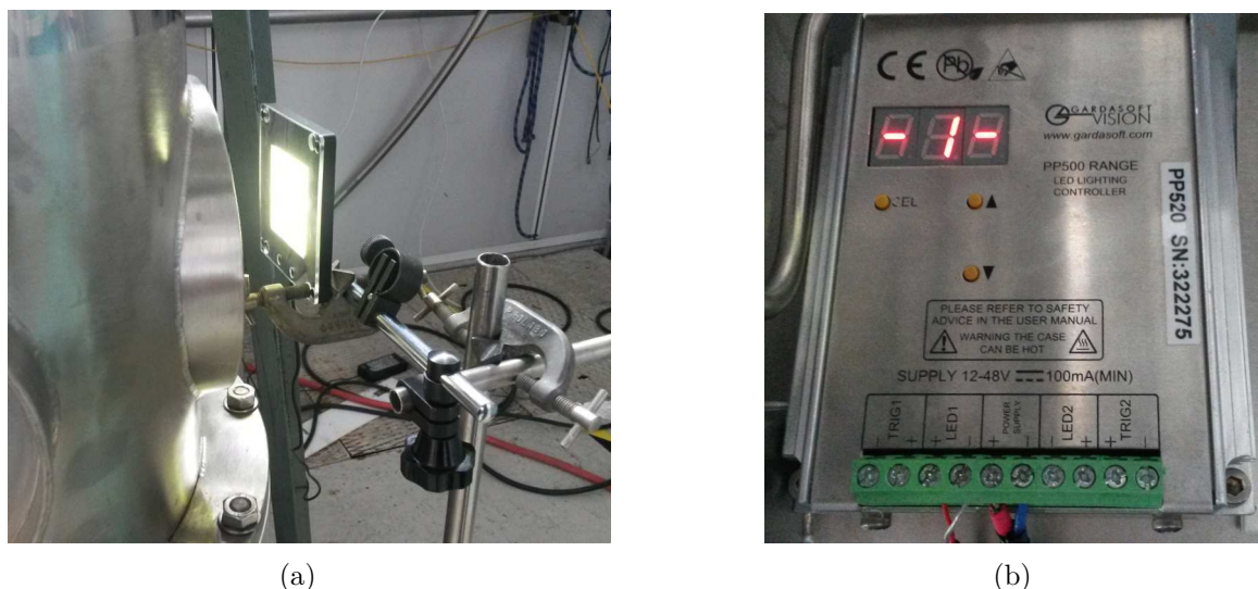
FIGURE 3.4 – (a) Panneau de led (b) Système d'alimentation et de commande du panneau de led
