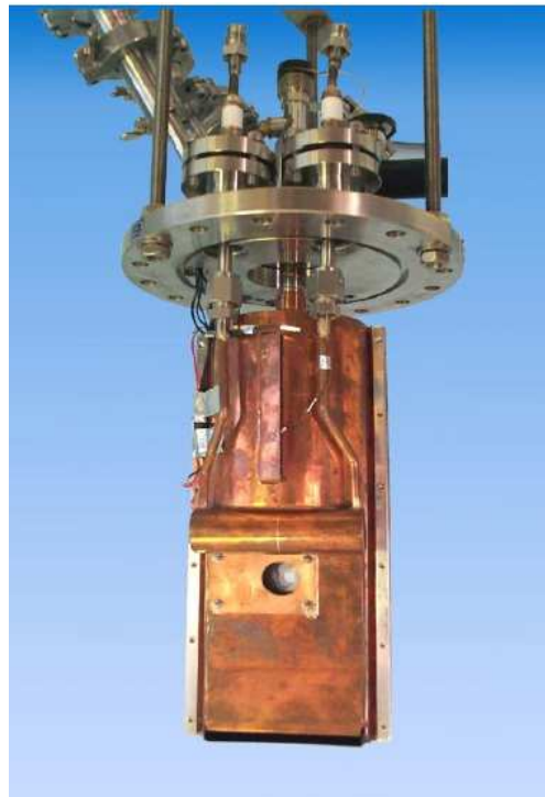
FIGURE 1.6 – à gauche : principe de formation des cibles minces d’hydrogène solide développées au GANIL, à droite : vue d’ensemble du système, entourée d’un écran thermique à 80 K
