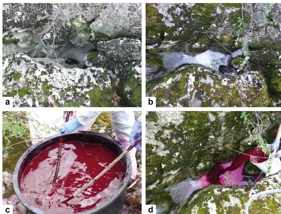
FIGURE 4.6 – Traçage de la perte de Brestalou de Claret. a) Photographie de la perte en période d'étiage; b) Photographie de la perte en période de crue lorsque la rivière coule; c) Préparation de la solution d'injection (10 kg de Sulphorhodamine B dans 100 l d'eau); d) Infiltration directe au niveau de la perte.
