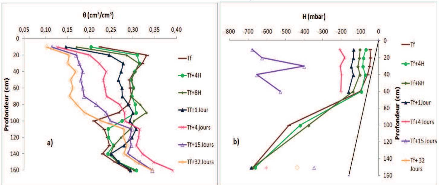
**Figure 4.22:** Profil hydrique (a) et potentiel total (H) (b) durant la phase de redistribution. Scénario avec palmier dattier.  $T_f$ : fin de l'infiltration.
