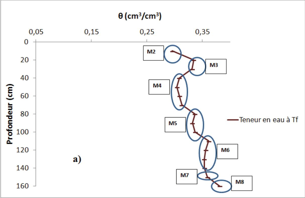
**Figure 4.8:** Discrétisation du profil de sol grâce au profil de teneur en eau mesuré à la fin de l'infiltration de l'expérience 1.
