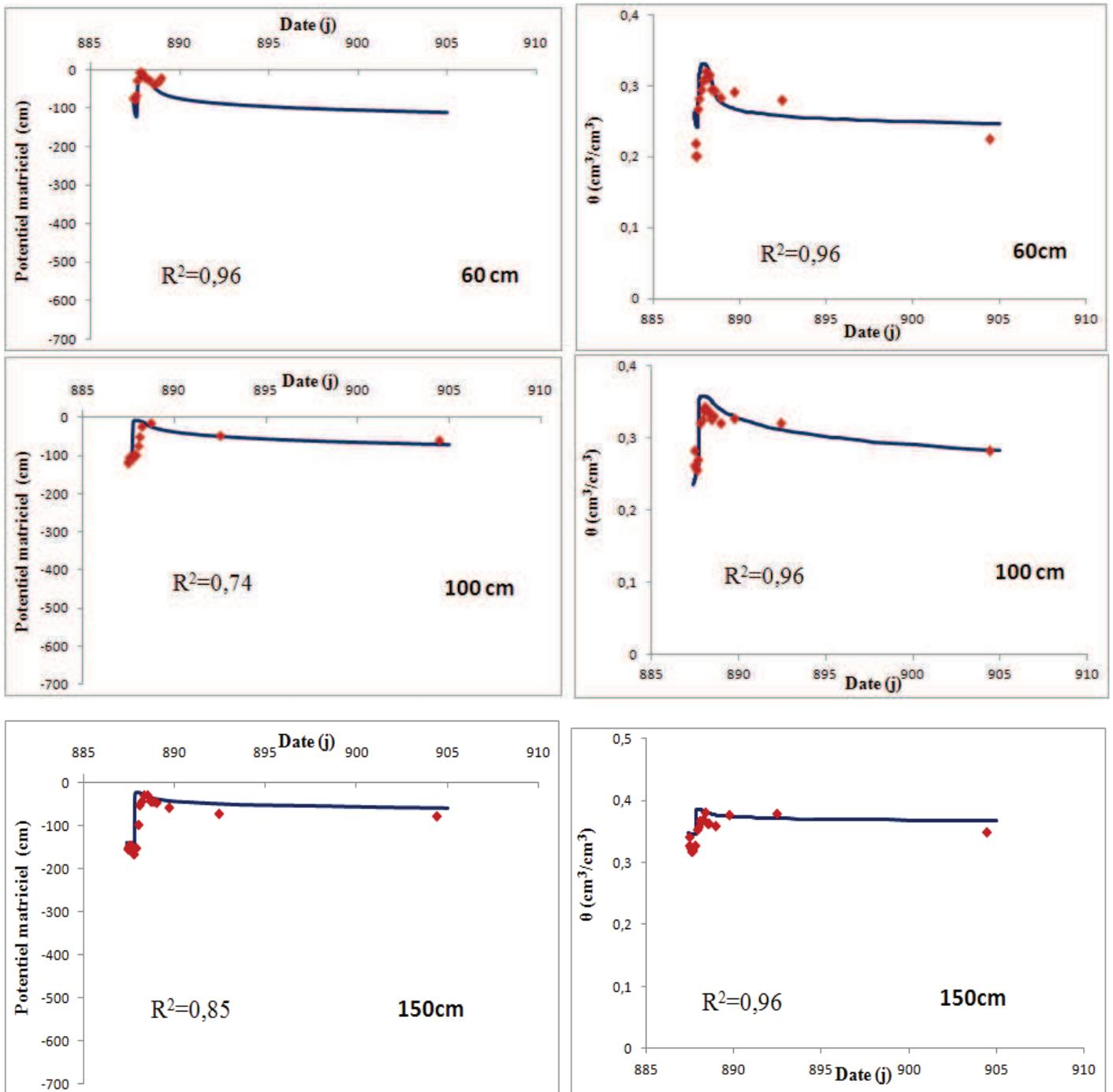
**Figure 4.9 (fin):** Dynamique hydrique simulée à l'aide d'HYDRUS-1D après optimisation par calage des paramètres hydriques du sol pour les différentes profondeurs instrumentées avec les tensiomètres et la sonde à neutrons ;  $T_0=887,42$  j.
