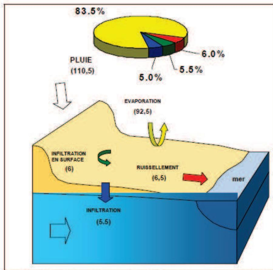
**Figure 1.7 :** Schéma du cycle hydrologique du bassin versant de l'oued d'Ambouli (en millions de m<sup>3</sup>) (CHA, 1982, cité par Bouh, 2006).
