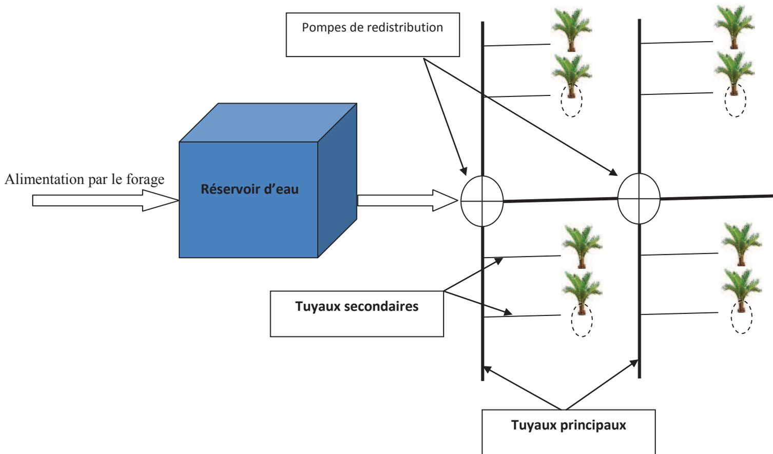
**Figure 3.5 :** Schéma du système d'irrigation de la palmeraie.
