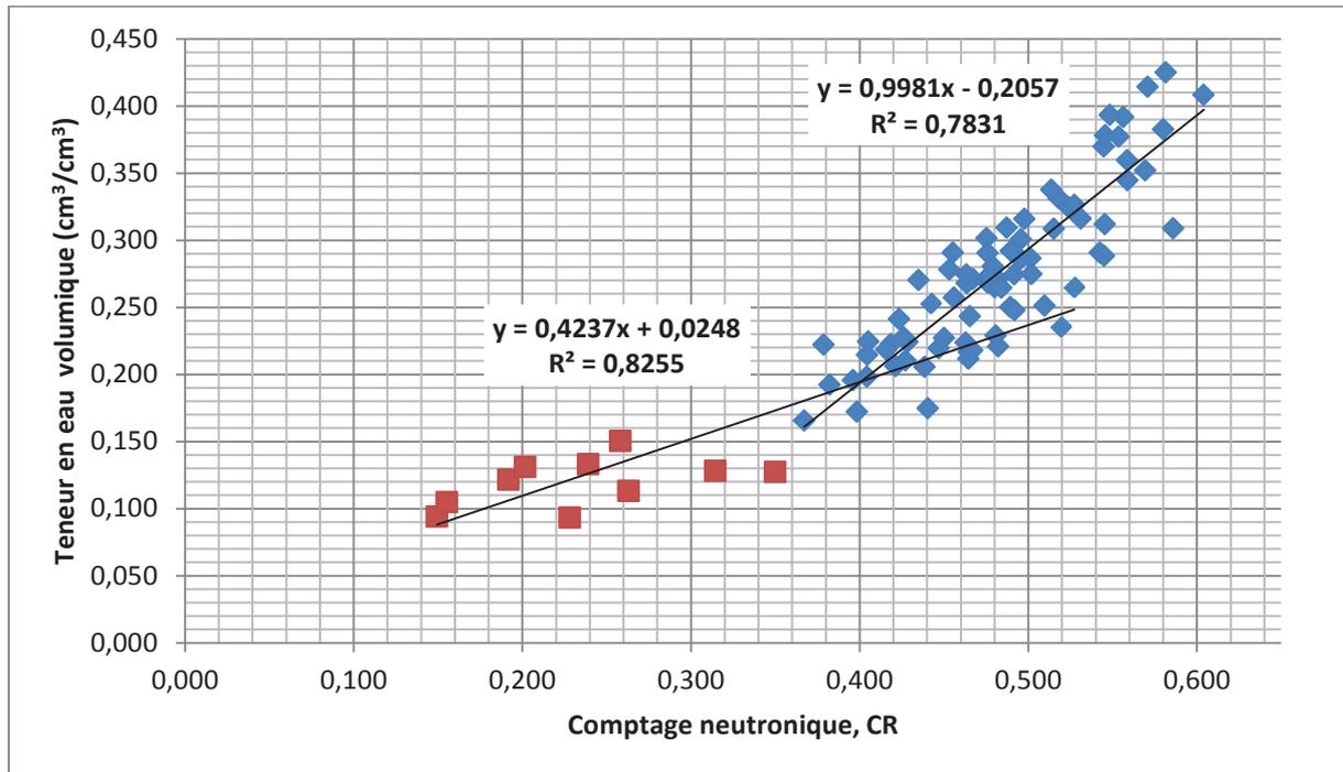
**Figure 3.18 :** Les deux droites de régressions : celle des points de surface (10 cm), des points de profondeurs 20 cm des tubes Dd, Da, Fb et celui de la profondeur 30 cm du tube Dd et celle des autres points de profondeur  $\geq 20$  cm.
