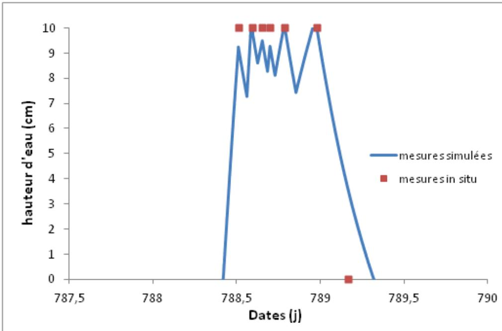
**Figure 4.24** : Hauteur de la lame d'eau en surface apportée pendant l'irrigation (mesures *in situ*) et valeurs de cette même hauteur d'eau simulée avec HYDRUS-1D ; scénario avec palmier ;  $T_0=788,42$  j.
