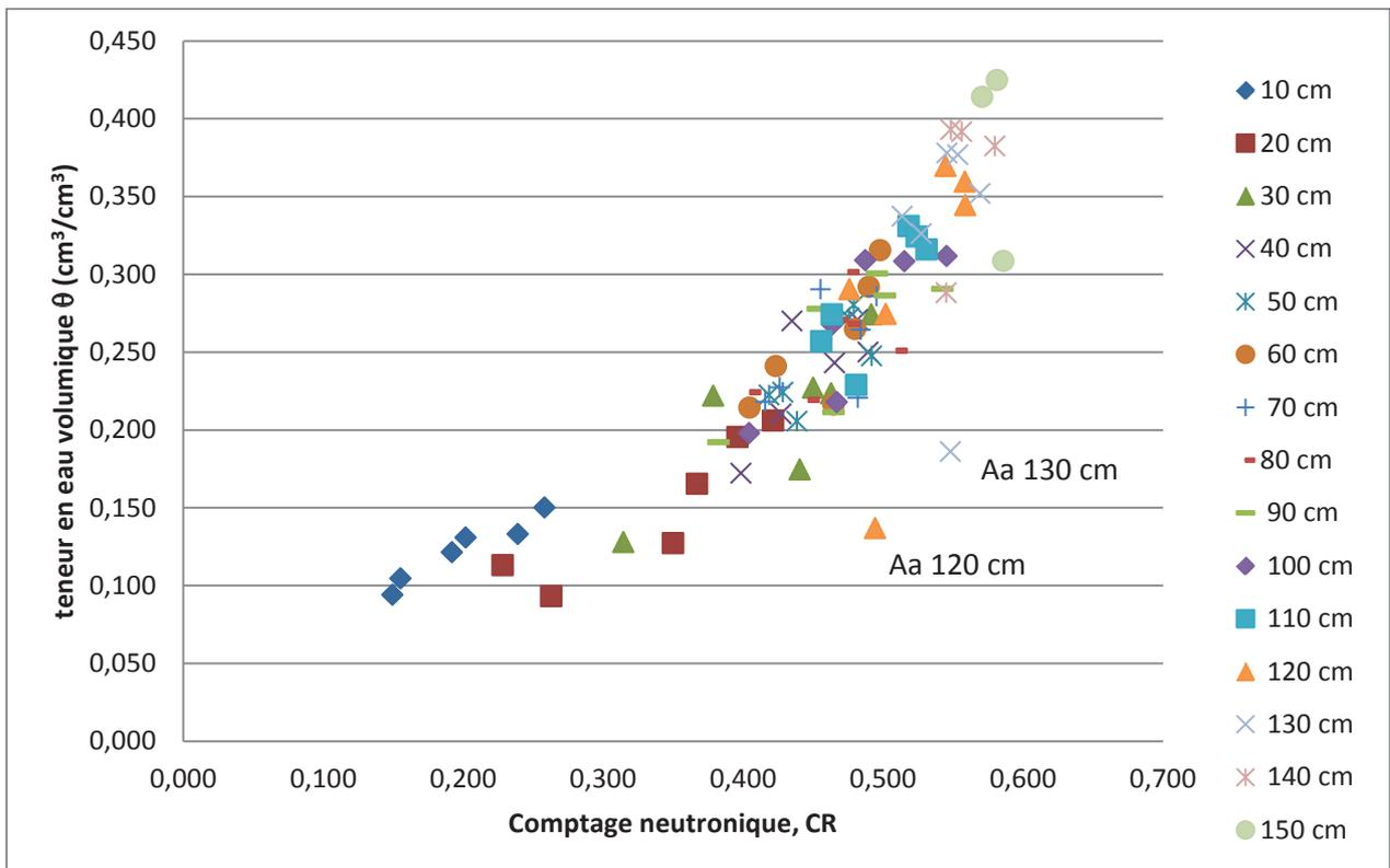
**Figure 3.14** : Relation entre comptage neutronique réduits (CR) et teneur en eau volumique ( $\theta$ ) mesurée le jour de l'installation des tubes d'accès de la sonde à neutrons, par niveaux de profondeur.
