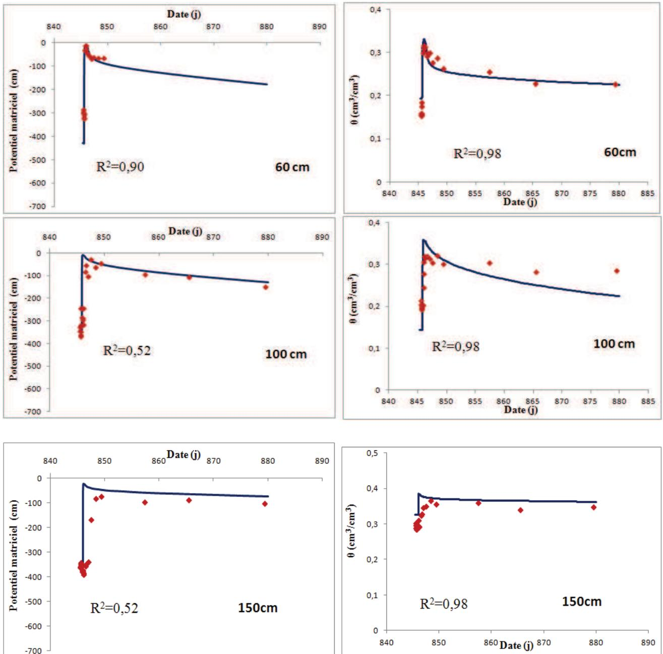
**Figure 4.17 (fin):** Dynamique hydrique simulée à l'aide d'HYDRUS-1D pour les différentes profondeurs instrumentées avec les tensiomètres et la sonde à neutrons pour le scénario sans palmier avec évaporation du sol ;  $T_0= 845,42$  j.
