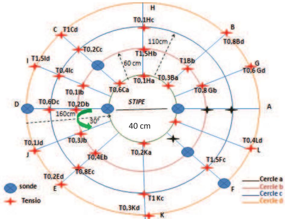
**Figure 3.13 :** Schéma de la répartition des tubes d'accès de la sonde et tensiomètre sous le palmier. Le nombre associé à chaque tensiomètre indique sa profondeur d'installation (en m).
