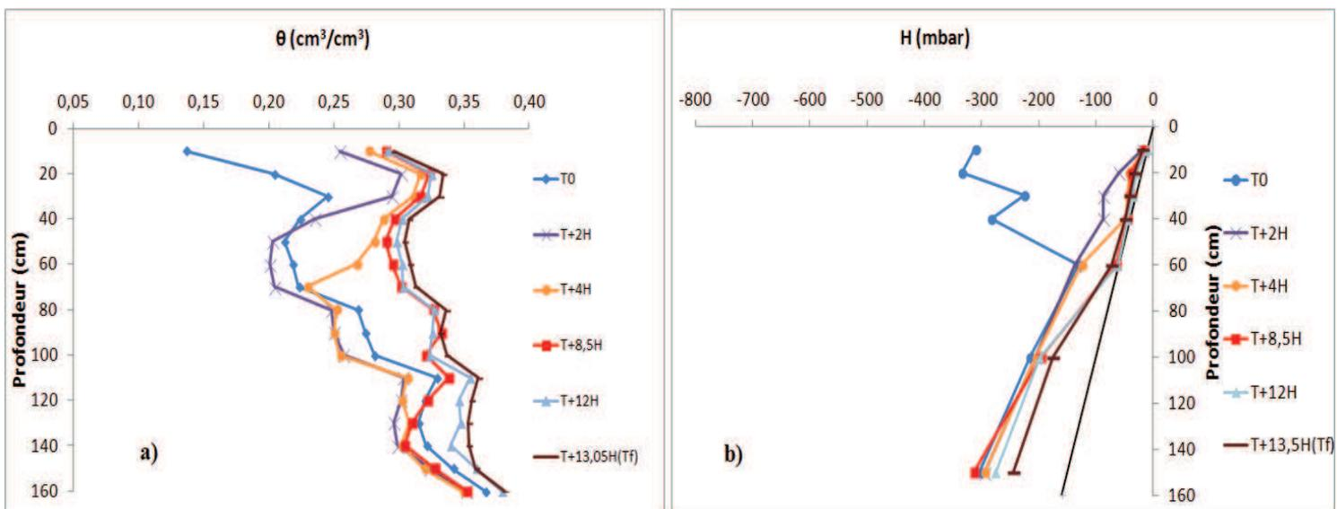
**Figure 4.3 :** Profil hydrique (teneur en eau,  $\theta$ , (a) et potentiel total, H (b)) durant la phase d'infiltration. Scénario sans palmier dattier et sans évaporation. T0 : début de l'infiltration, Tf : fin de l'infiltration.
