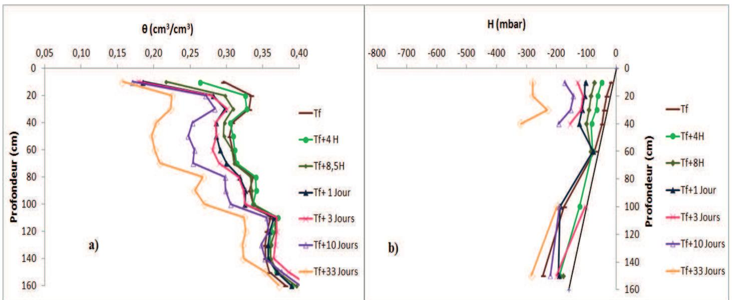
**Figure 4.4 :** Profil hydrique (teneur en eau,  $\theta$ , (a) et potentiel total,  $H$  (b)) durant la phase de redistribution. Scénario sans palmier dattier et sans évaporation.  $Tf$ : fin de l'infiltration.
