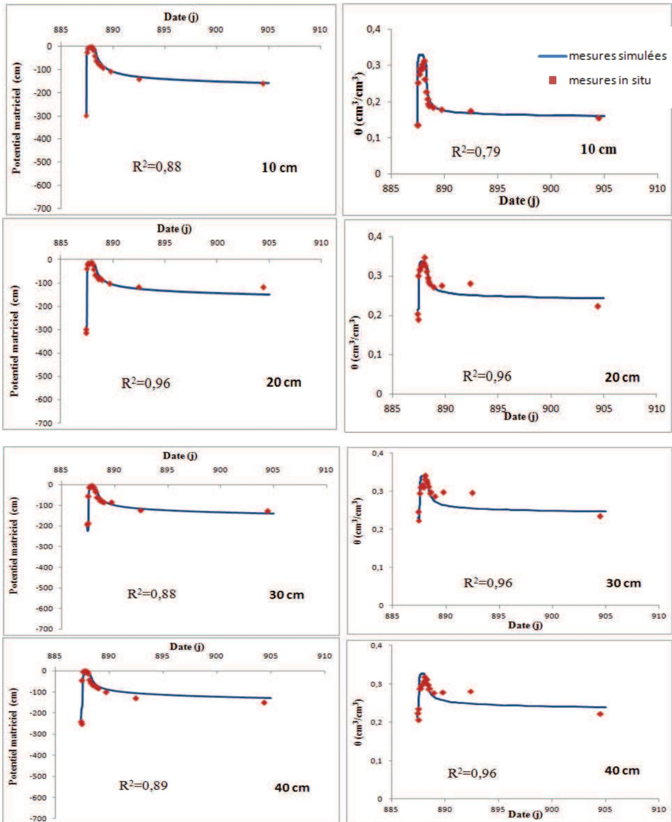
**Figure 4.9 (début) :** Dynamique hydrique simulée à l'aide d'HYDRUS-1D après optimisation par calage des paramètres hydriques du sol pour les différentes profondeurs instrumentées avec les tensiomètres et la sonde à neutrons ;  $T_0= 887,42$  j.
