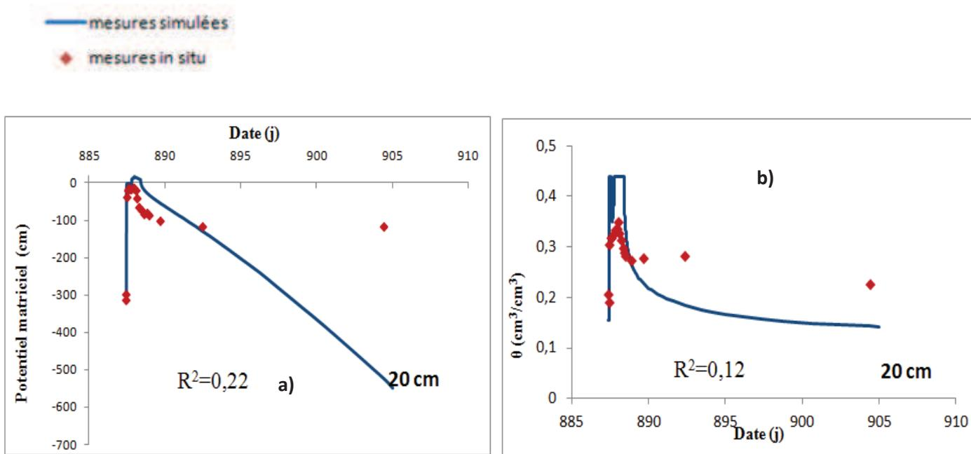
**Figure 4.7 :** Valeurs de potentiel matriciel (a) et de teneur en eau volumique (b) mesurées *in situ* à la profondeur 20 cm et simulées avec HYDRUS 1-D avec les paramètres hydrodynamiques obtenues avec ajustement RETC au laboratoire et  $\theta_s$  fixée 90 % de la porosité.
