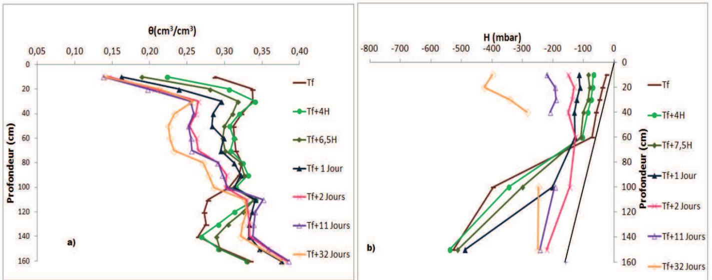
**Figure 4.14 :** Profil hydrique (a) et potentiel total (H) (b) durant la phase de redistribution. Scénario sans palmier dattier avec évaporation. *T<sub>f</sub>* : fin de l'infiltration.
