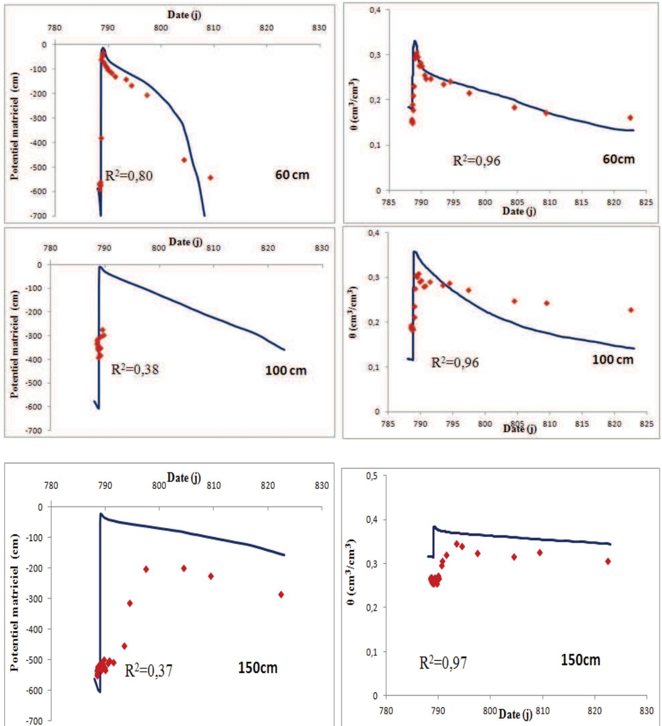
**Figure 4.25 (fin):** Dynamique hydrique simulée à l'aide d'HYDRUS-1D pour les différentes profondeurs instrumentées avec les tensiomètres et la sonde à neutrons pour le scénario avec palmier ;  $T_0=788,42$  j.
