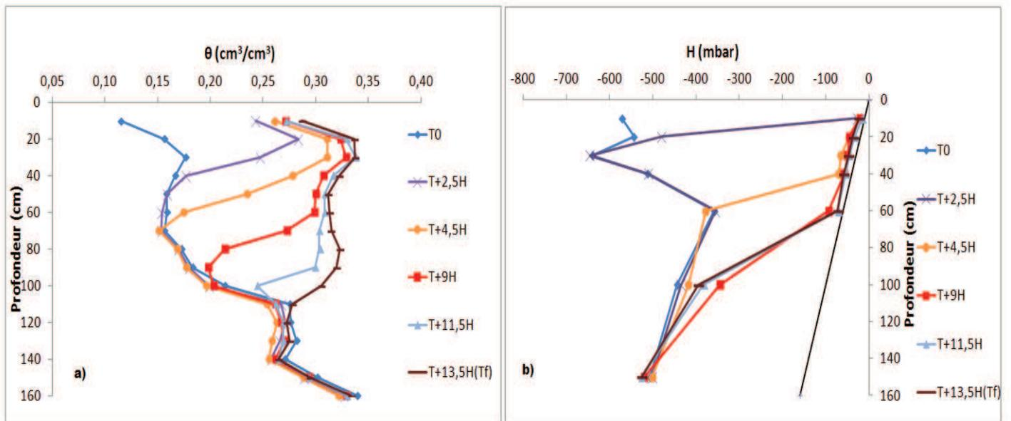
**Figure 4.13:** Profil hydrique (a) et potentiel total (H) (b) durant la phase d'infiltration. Scénario sans palmier dattier avec évaporation.  $T_0$  : début de l'infiltration,  $T_f$  : fin de l'infiltration.
