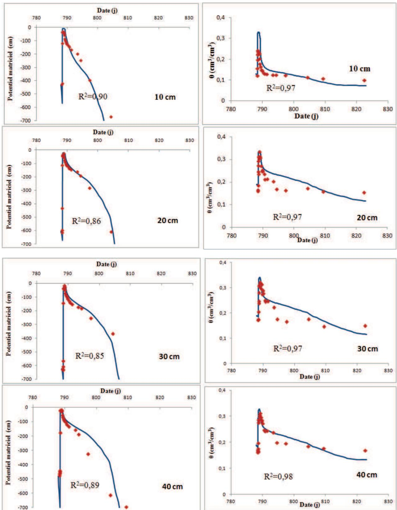
**Figure 4.25 (début):** Dynamique hydrique simulée à l'aide d'HYDRUS-1D pour les différentes profondeurs instrumentées avec les tensiomètres et la sonde à neutrons pour le scénario avec palmier ;  $T_0=788,42$  j.
