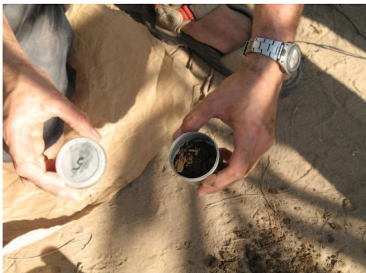
**Photo 3.10:** Echantillons de sol prélevés pour l'estimation de la teneur en eau massique le jour de l'installation de tubes.
