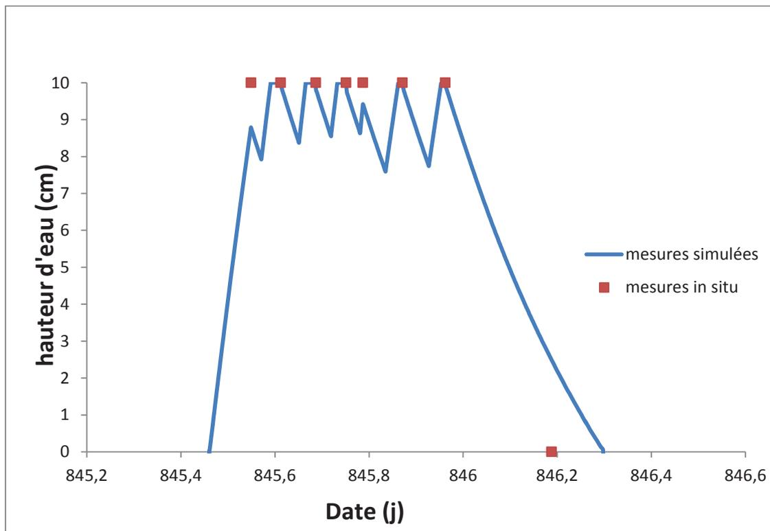
**Figure 4.16 :** Hauteur de la lame d'eau en surface apportée pendant l'irrigation (mesures *in situ*) et valeurs de cette même hauteur d'eau simulée avec HYDRUS-1D (mesures simulées) ; scénario sans palmier avec évaporation;  $T_0 = 845,42$  j.
