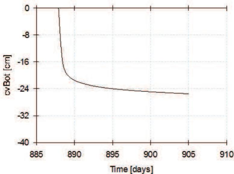
**Figure 4.11** : Drainage cumulé simulé avec HYDRUS-1D pour le sol nu sans évaporation ;  $T_0 = 887,42$  j.
