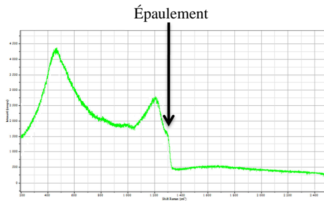
Figure 37 : Spectre Raman d'un échantillon de diamant dopé bore sur SiC
