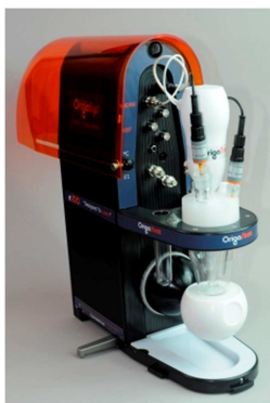
Figure 46 : Potentiostat Origastat OGS 100 et électrodes en solution
