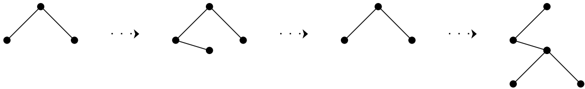
FIGURE 2.1 – Une illustration d’un arbre dynamique par une suite de graphes qui représente l’évolution de l’arbre dynamique dans le temps. Le graphe évolue par l’ajout ou la suppression de nouveaux éléments tout en gardant la propriété d’être un arbre.
