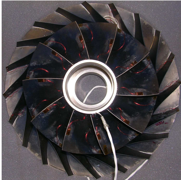
FIGURE 2.14 – Instrumentation en jauges d'extensométrie sur le rouet
