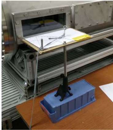
FIGURE 2.13 – L’observation de l’angle entre la paroi verticale de la cuve et le bord du plasma permet de remonter simplement à sa longueur par trigonométrie.
