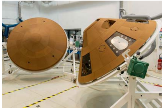
FIGURE 5.18 – Bouclier thermique de la capsule Schiaparelli (EXOMARS 2016) avant et arrière.
