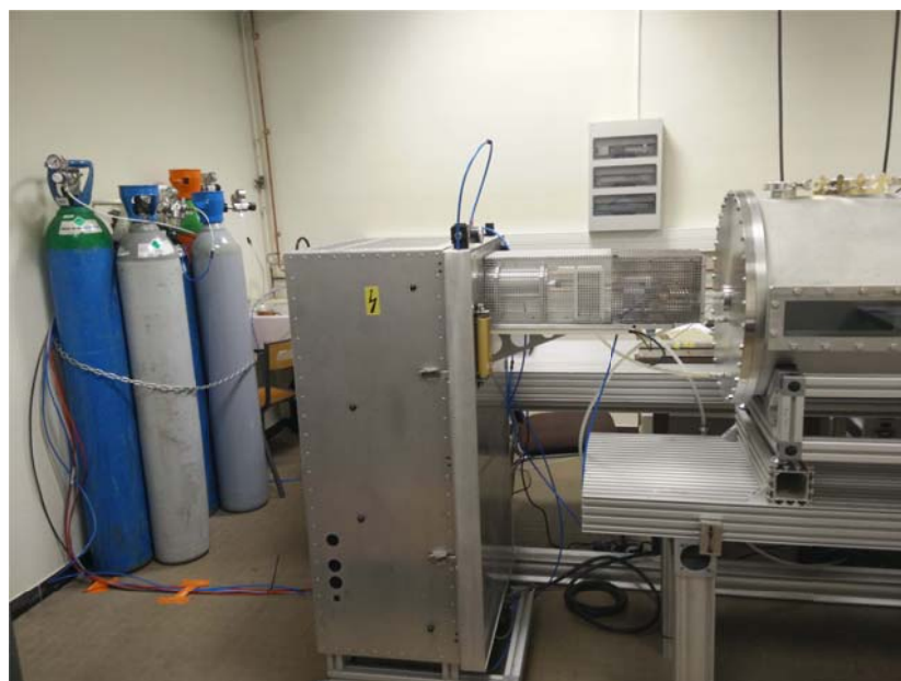
FIGURE 2.4 – Au milieu : la torche et son alimentation, à gauche les bouteilles de gaz, à droite la cuve basse pression.
