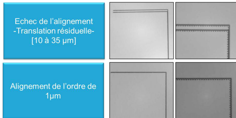
Figure 4.36 : Observations infrarouge des verniers présents sur les puces hydrophiles, réalisées avec des grossissements différents.
