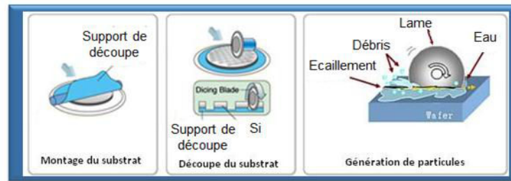
Figure 4.76 : Les étapes du procédé de découpe par scie diamantée.
