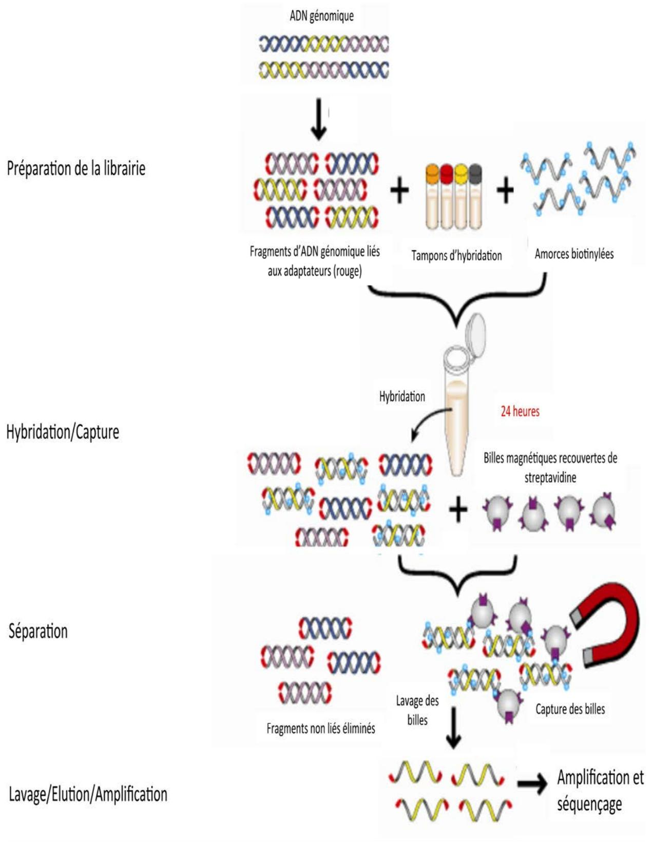
**Figure 15:** Procédure de capture des exons selon le SureSelect Targeted Enrichment Workflow (Agilent Technologies, California, USA).
