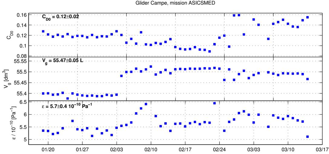
Fig. B2.3 Paramètres du glider optimisés pour la mission ASICSMED du glider Campe : de haut en bas, le coefficient de traînée  $C_{D_0}$ , le volume du glider  $V_g$  et la compressibilité  $\epsilon$ . On a indiqué pour chaque paramètre sa valeur moyenne et son écart type lors du déploiement complet.
