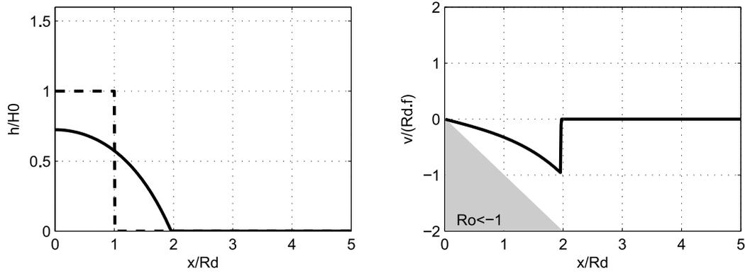
Fig. C1.5 Solution de l'ajustement géostrophique à  $1^{1/2}$  couche d'une parcelle profonde initialement au repos caractérisée par  $L_0 = 1$  et  $H_0^3 = 1$ . On représente : (à gauche) la hauteur initiale en pointillé et la solution en trait plein ; (à droite) la vitesse.
