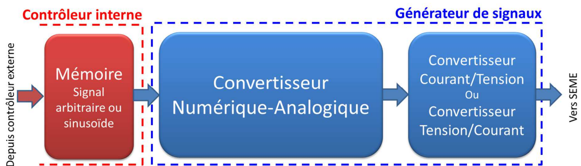
Fig. 11-3 : Sous-fonctions du générateur de signaux.
