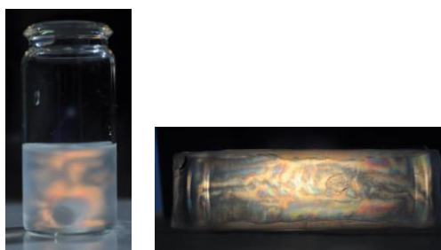
Figura 5.2 Fotografias da suspensão aquosa de NCC_CMC (a) e do filme de NCC (b) observados entre lentes polarizadoras.
