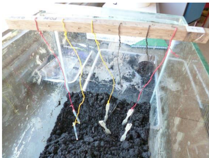
Figura 4.19 Sistema utilizado para ensaio de biofragmentação das amostras.
