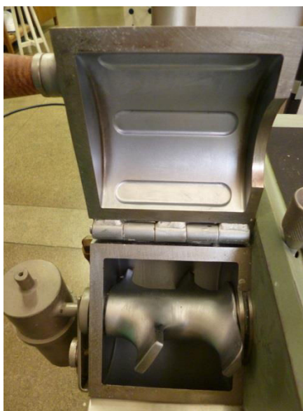
Figura 4.14 Foto mostrando o detalhe do rotor do misturador de alta rotação do tipo Drais.
