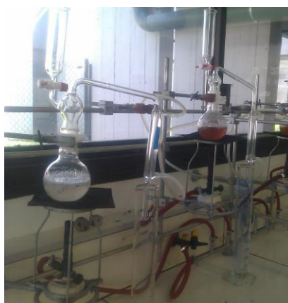
Figura 4.17 Sistema de destilação usado para determinação do teor de pentosana presente na balsa.
