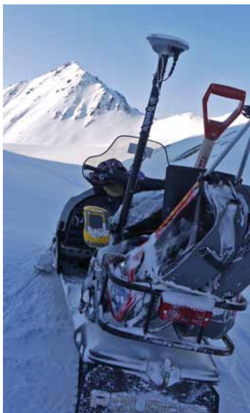
Figure 72 – Skidoo et DGPS, une association pour dresser un MNT précis. L'antenne du DGPS est fixée sur le skidoo et sa hauteur est déduite de la mesure. Le glacier est ensuite parcouru le plus densément possible à très faible allure. Cette démarche permet d'enregistrer un grand nombre de points qui, après post-traitement, serviront à établir un MNT de surface de l'année en cours (Cirque du Grønlietoppen, avril 2011).
