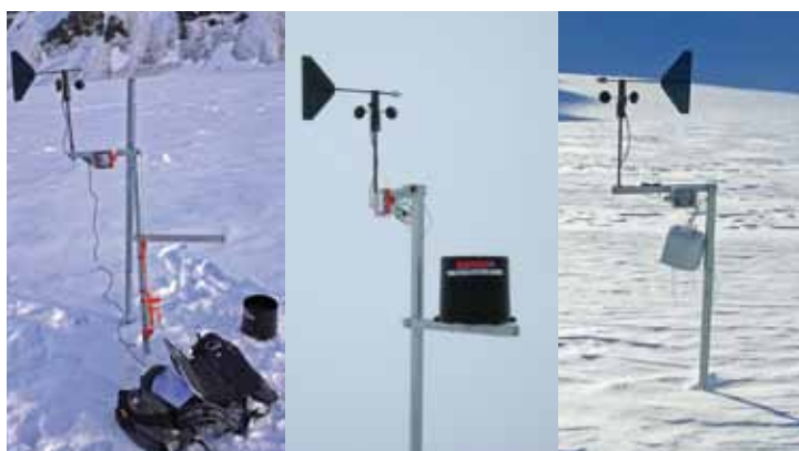
Figure 86 – Les anémomètres et les pluviomètres sont installés sur des mâts en aluminium et couvrent le glacier par tranches d'altitudes. Leur fonctionnement est en revanche plus difficile que celui des capteurs de températures, et parfois, on rencontre de mauvaises surprises en automne.
