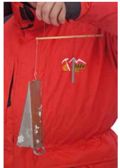
Figure 200 – Le système chinois de peson pour estimer la densité du manteau neigeux.
