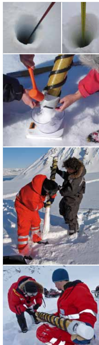
Figure 99 – Les contraintes hivernales, de température et de vent, nécessitent d'emmener les échantillons à la base pour les peser et effectuer les prélèvements. Les carottes sont alors vidées dans des gaines en plastique numérotées. Plus tard en saison, toutes les manipulations ont lieu sur le terrain, dont la pesée qui a été adaptée (Photos bas : M. Griselin, avril 2008 et Ch. Marlin, printemps 2009).
