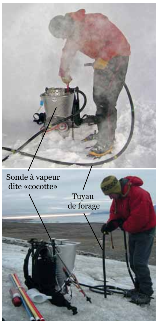
Figure 104 – Les balises utilisées sont en plastique pour les zones d’ablation. Des balises complémentaires en zone d’accumulation ont été remplacées par des mâts en aluminium. Les campagnes d’implantation des balises se font en toute saison bien que l’automne soit une période plus propice, surtout si on bénéficie d’une aide ! (photos : M. Griselin, juillet 2007 et avril 2010).
