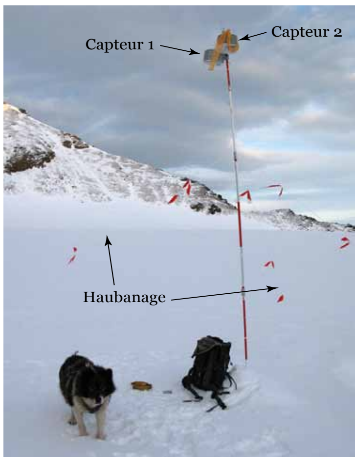
Figure 85 – Le point n°24 a été équipé de deux enregistreurs de températures permettant ainsi d'estimer une marge d'erreur. Même pour des capteurs strictement identiques et étalonnés en laboratoire, on constate une différence significative (maintenance des capteurs et préparation pour l'hiver, octobre 2009 ; merci à Frost pour la logistique !)
