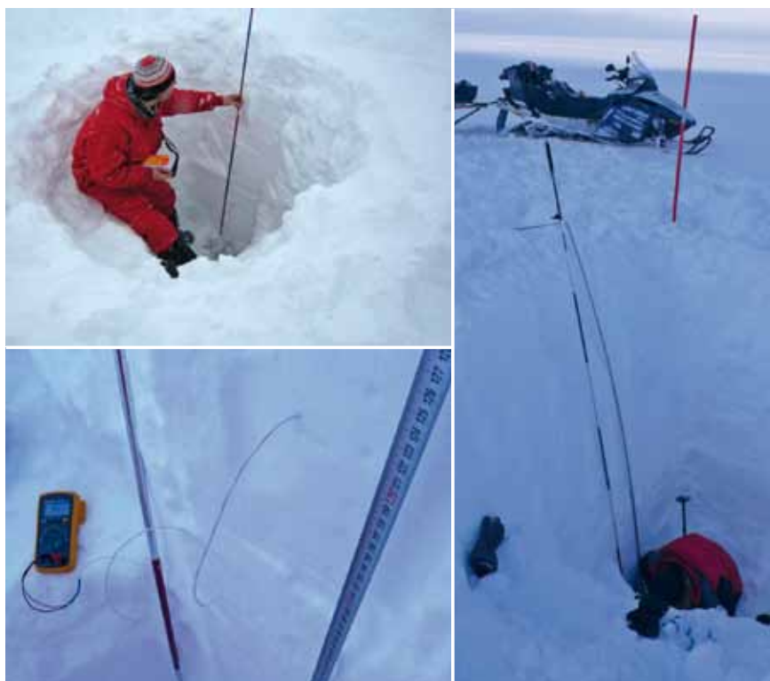
Figure 102 – La réalisation du profil nivologique permet de dresser un portrait du manteau neigeux et d'associer des mesures quantitatives comme la température et la densité. Pour chaque point d'échantillonnage, un puits à neige est ainsi creusé jusqu'à l'interface glace-neige (photos des différentes campagnes d'avril 2008 - M. Griseilin-, 2009 et 2010).
