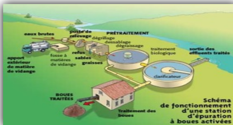
Figure N°35: Station d'épuration à boues activées
