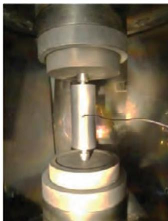
Figure II-7 Photographie de la matrice WC/Co et du thermocouple lors de la mise en place dans le SPS.
