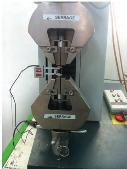
Figure A-8 Montage de la machine de traction pour les essais sur les éprouvettes « os de chien ».
