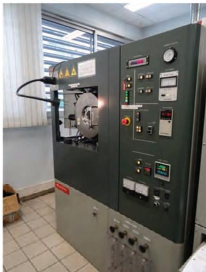
Figure A-2 Photographie de la machine Sumitomo Dr Sinter 2080 SPS
