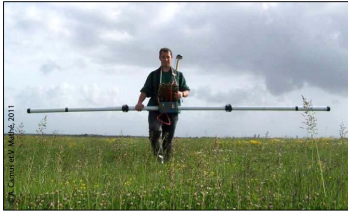
Fig. 41 – Mise en œuvre du conductivimètre Geonics EM31-MK2. Source : Camus et Mathé, 2011b.
