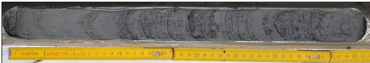
Fig. 44 – Exemple de structure litée. Alternance de lits sableux et limono-sableux entre 500 et 550 cm de profondeur, séquence ISG1309.
