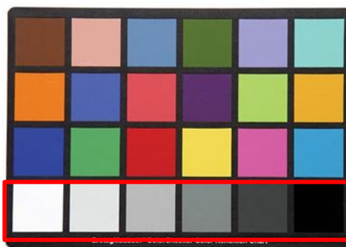
Figure 14 : Charte colorimétrique de MacBeth et présentation des six patches neutres
