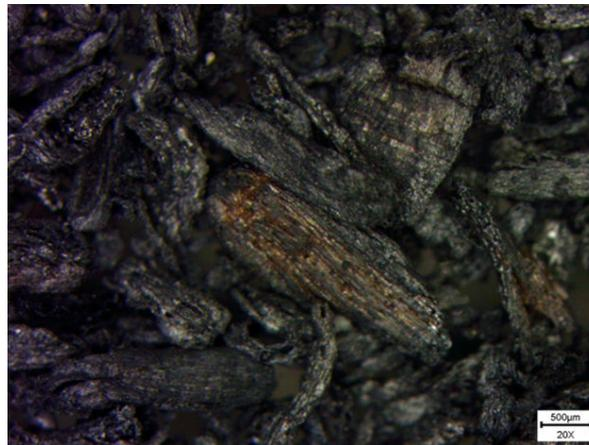
FIGURE 6.6 – Photographie de particules de char échantillonnées dans l'eau de la trempe durant la gazéification du lot LX-30-B (2 bara,  $\lambda = 0,27$ )
