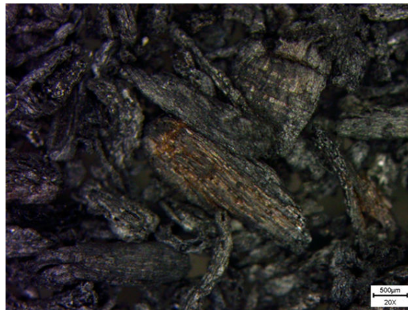
FIGURE 6.6 – Photographie de particules de char échantillonnées dans l'eau de la trempe durant la gazéification du lot LX-30-B (2 bara, \lambda = 0,27 )
