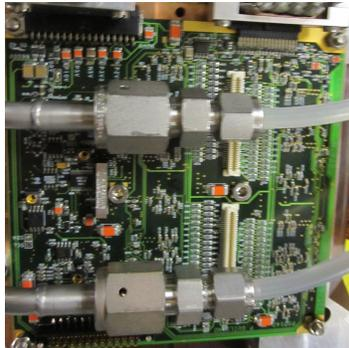
FIGURE 3.25 – Cartes MUFEE et le système de refroidissement
