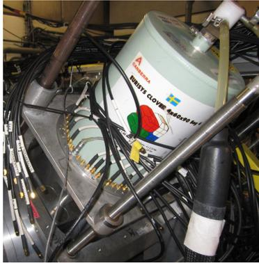
FIGURE 3.12 – Clover composé de 4 cristaux et d'un cryostat
