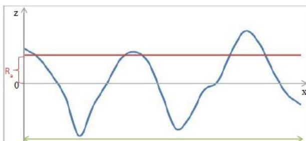
Figure II-2 : Profil linéaire d'une topographie de surface réalisée par AFM permettant le calcul du Ra
