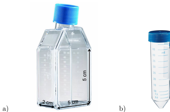
FIGURE 4.1 – a) Flasque de culture biologique 25 \text{ cm}^2 . b) Tube de culture « Falcon ».
