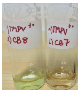
Figure 14. Mélanges de \text{TV}^{3(++)} et CB[8] (pas de précipitation, couleur verte, à gauche) et de \text{TV}^{3(++)} et CB[7] (précipitation, couleur rougeâtre, à droite).
