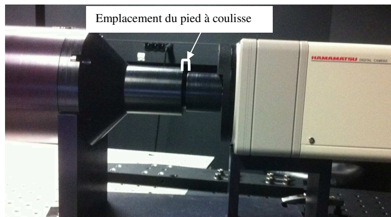
Figure 63 : La connexion entre l'arrière du conoscope (noire) et la caméra (gris et beige).
