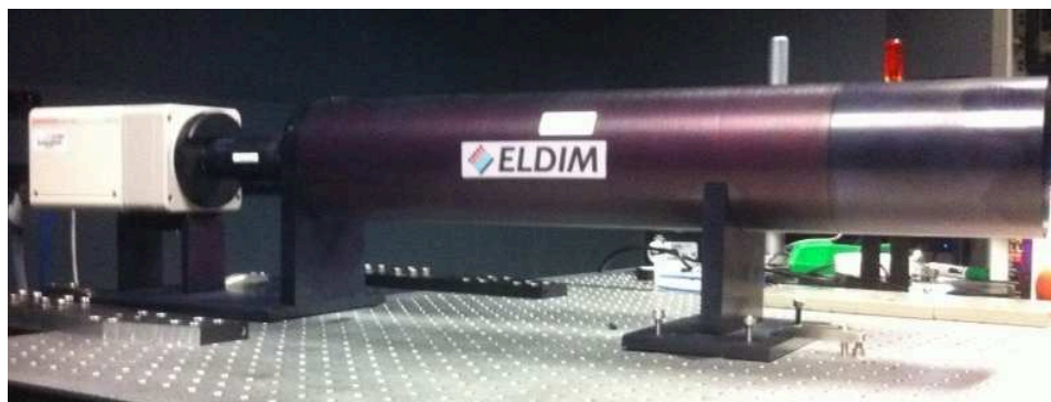
Figure 61 : Image de la détection montée sur la table optique.
