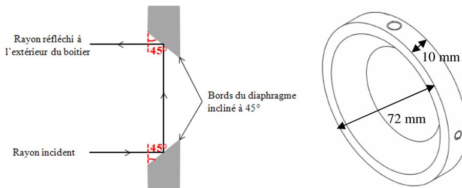
Figure 39 : Schéma représentatif du design du diaphragme d'ouverture.
