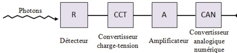
Figure 54 : La chaîne de détection d'une caméra.
