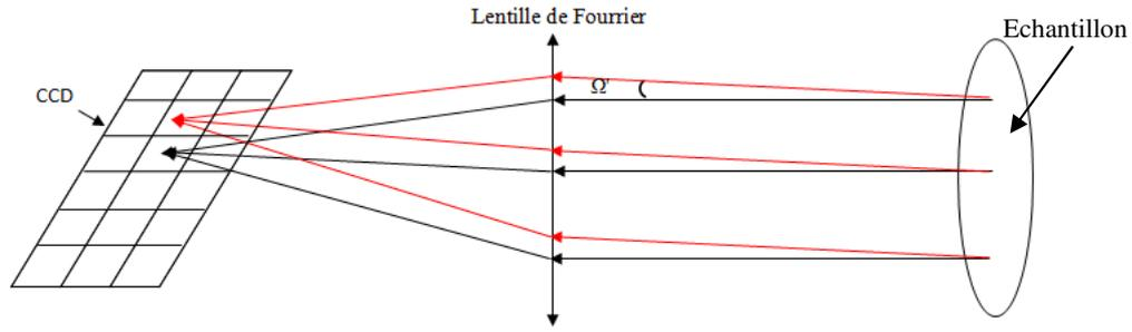
Figure 57 : Représentation schématique de la partie détection pour le calcul des flux sur un pixel. Les rayons parallèles provenant de l'échantillon sont focalisés à l'aide de l'optique de Fourier sur l'un des pixels du CCD.  $\Omega'$  est l'angle solide dans lequel le flux émis par l'échantillon est collecté par un seul pixel.
