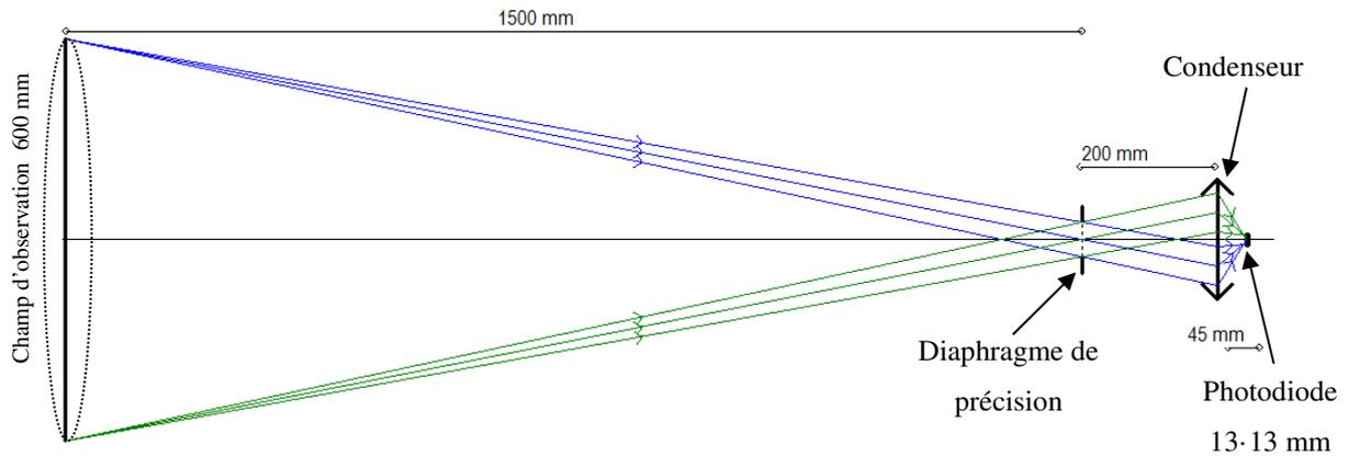
Figure 36 : Premier système optique imaginé pour la détection.
