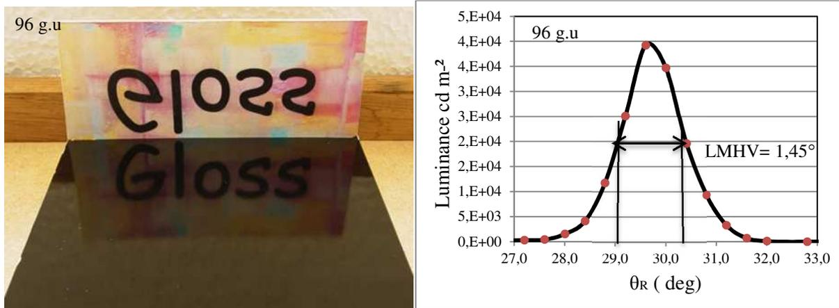
Figure 74 : Pic spéculaire d'un échantillon brillant.
