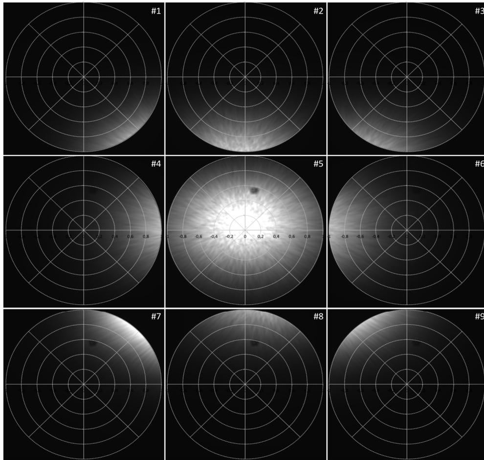
Figure 77 : Les 9 clichés utilisés pour reconstruire le pic spéculaire d'un échantillon de papier noir brillant. Pour une incidence avec un angle zénithal de  $45^\circ$ . Chaque cliché est centré sur une direction d'observation donnée décalée de plus ou moins  $1,5^\circ$  en zénith, et en azimut.
