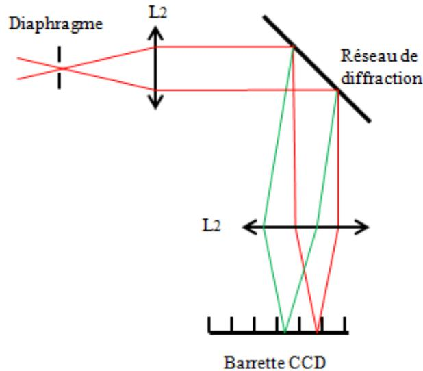
Figure 21 : Schéma représentatif du principe de fonctionnement du spectroradiomètre à CCD. Le faisceau lumineux est diffracté par le réseau de diffraction. Les faisceaux monochromatiques sont ensuite détectés par une barrette CCD ou une matrice.
