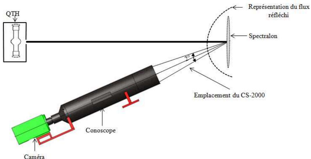
Figure 68: Schéma du montage de caractérisation du CCD.
