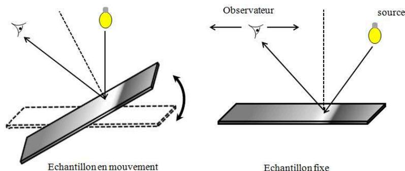
Figure 7 : Illustration de l'expérience d'évaluation visuelle du brillant.
