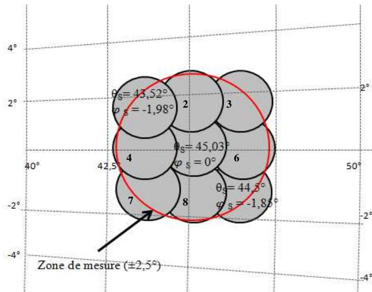
Figure 76 : Principe de la multi-exposition spatiale.
