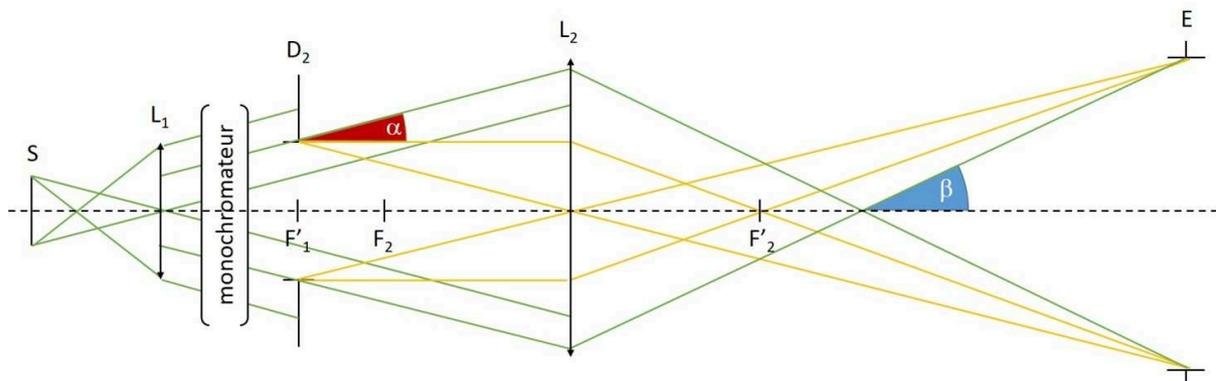
Figure 32 : Schéma descriptif de la voie d'illumination spectrale
