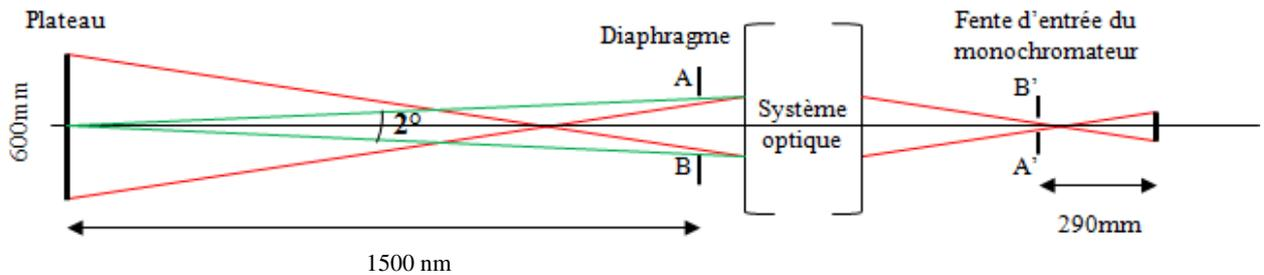
Figure 35 : Principe de la chaîne de détection.
