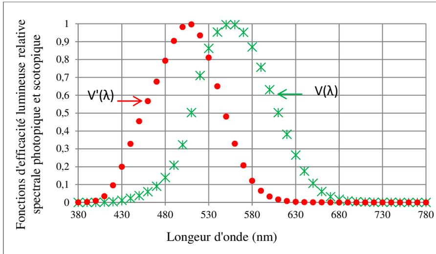
Figure 4 : Valeurs de l'efficacité lumineuse relative spectrale en vision photopique  $V(\lambda)$ .  $\lambda_M = 555 \text{ nm}$  (Jaune-vert) et scotopique  $V'(\lambda)$  avec  $\lambda_M = 507 \text{ nm}$  (Bleu-vert) [19].
