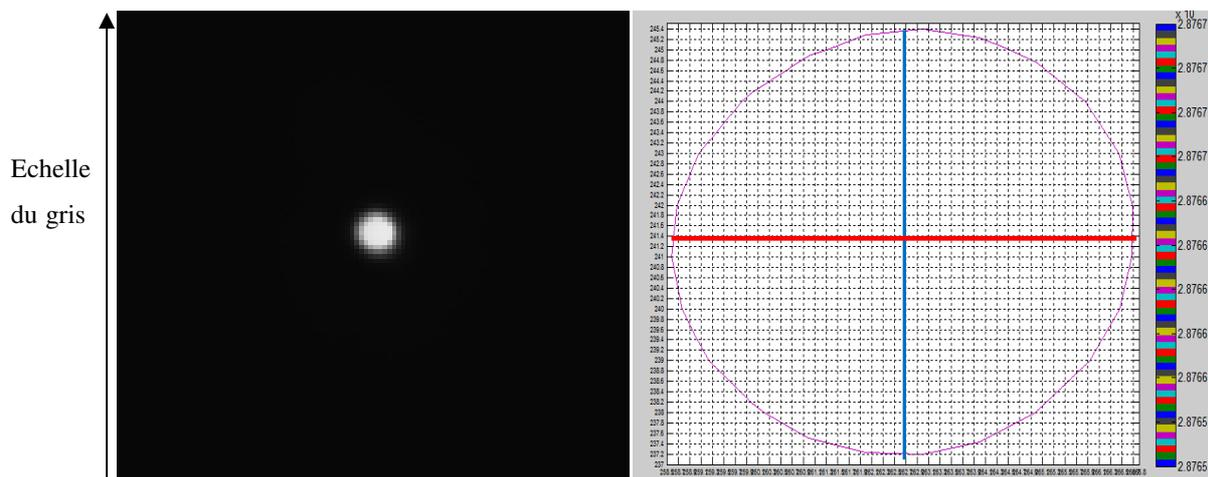
Figure 64 : Evaluation de la largeur à mi-hauteur du pic spéculaire.
