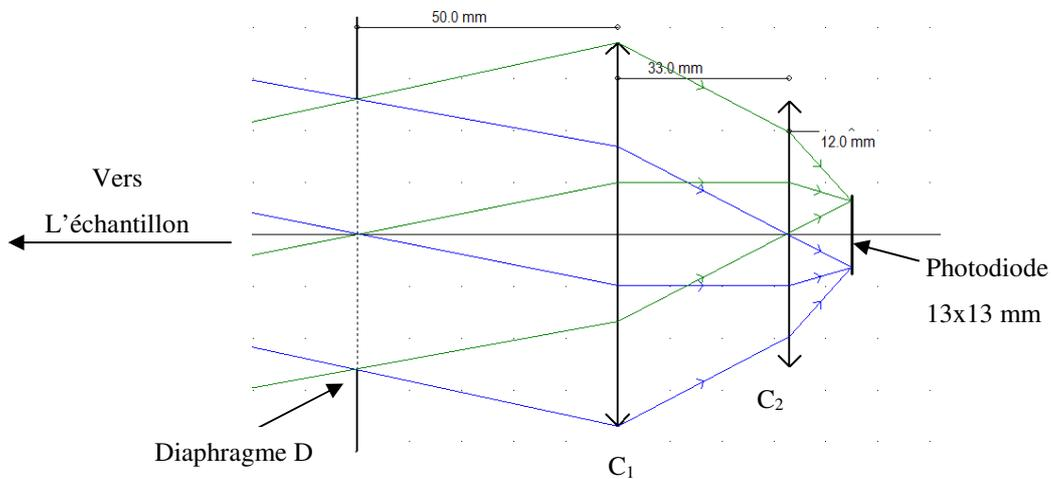
Figure 37 : Deuxième système optique imaginé pour la détection.
