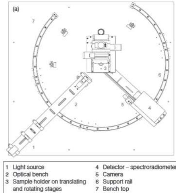
Figure 14 : Le goniospectrophotomètre du NPL [45].
