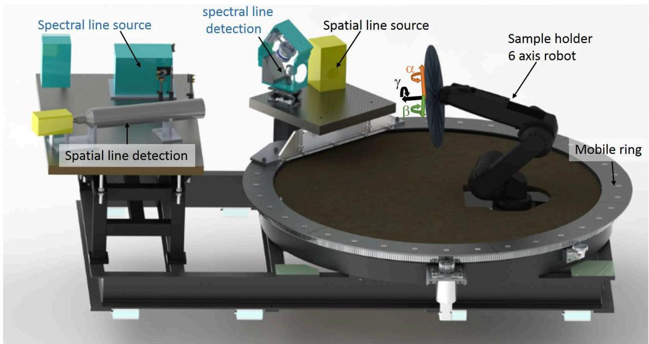
Figure 25 : Schéma général du gonioréfectomètre.
