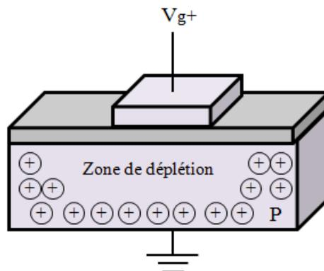
Figure 88: Schéma d'un MOS dopé P auquel on applique une tension à la grille  $V_g$  positive.
