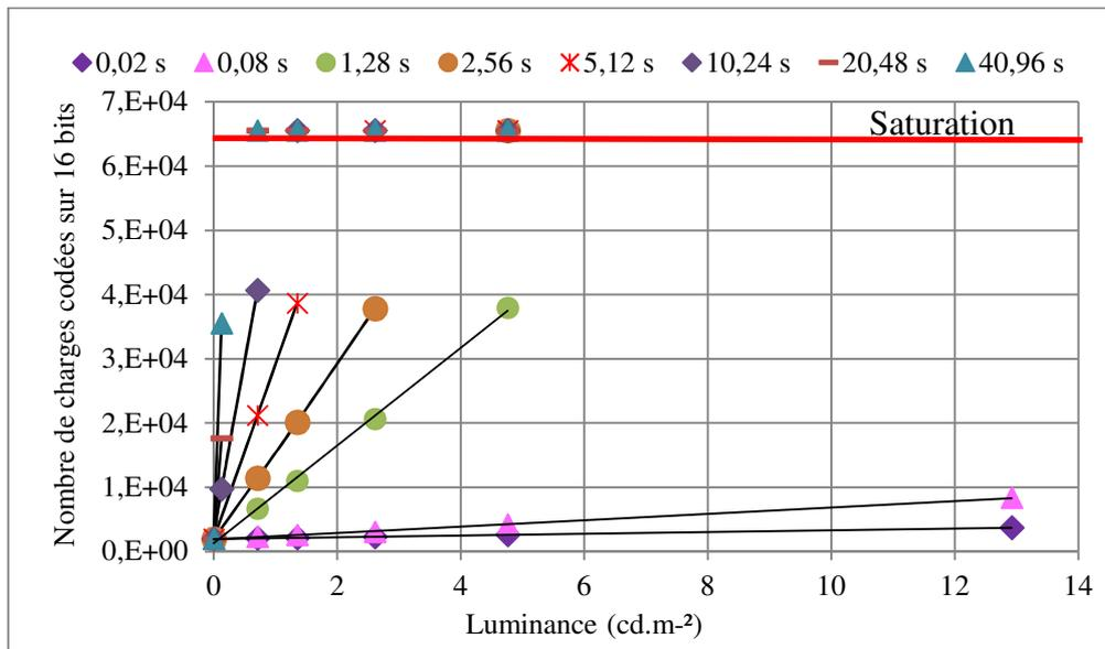
Figure 71 : Nombre de charges en fonction de la luminance pour différents temps d'exposition.
