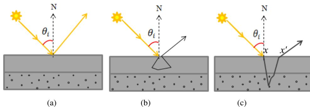
Figure 6 : Réflexion surfacique et réflexion sub-surfacique.
