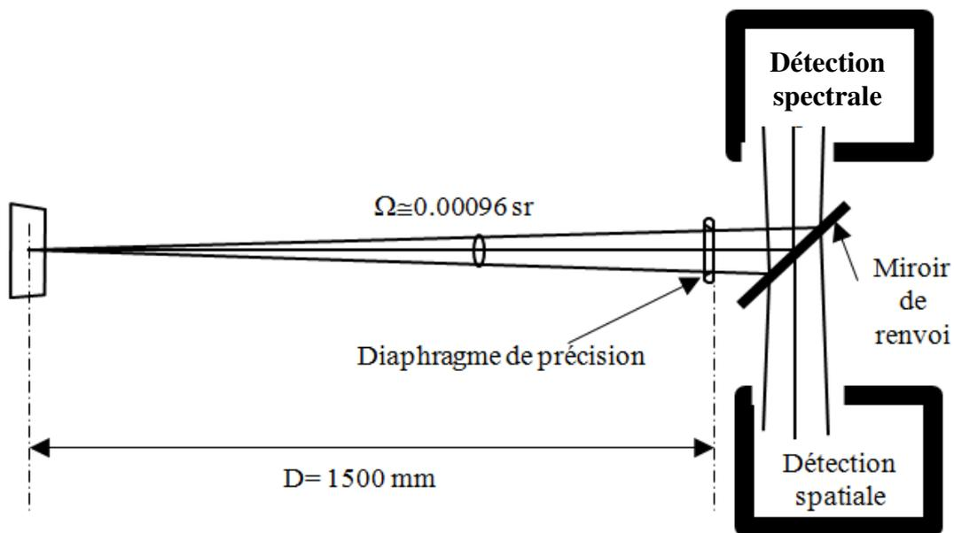
Figure 34 : Première configuration du gonioréfectomètre du LNE-CNAM.
