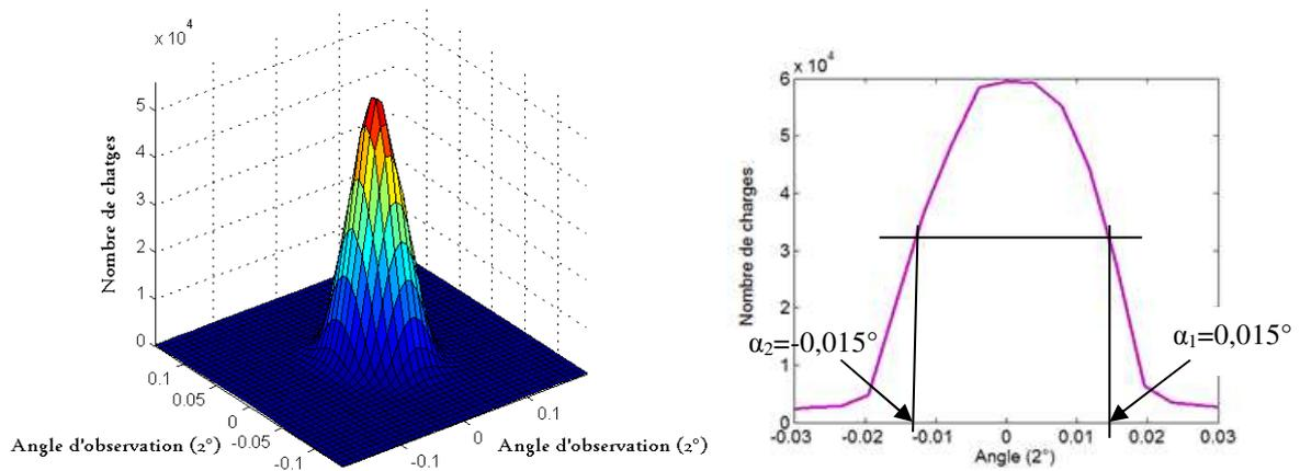
Figure 66 : Fonction de transfert de la détection spatial pour un sténopé de  $200\mu\text{m}$ . A gauche, le pic spéculaire en 3D. A droite, une coupe dans le plan d'incidence qui permet de valider une résolution de  $0,03^\circ$ .
