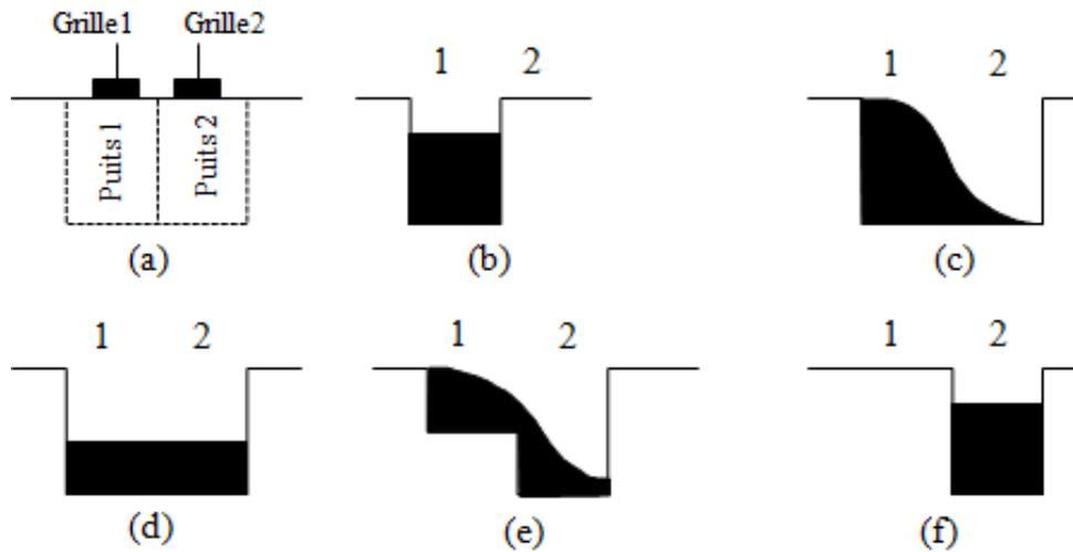
Figure 92 : Schéma représentatif du transfert de charge entre deux portes adjacentes [19].
