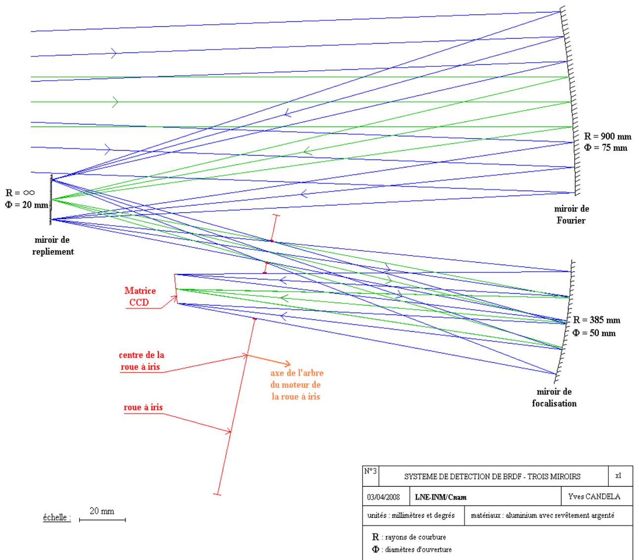
Figure 59 : Conception de la détection basée exclusivement sur l'utilisation de miroirs sphériques par Y. Candela [71].
