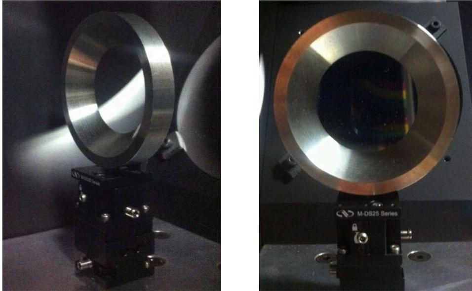
Figure 40 : Photo du diaphragme d'ouverture monté.
