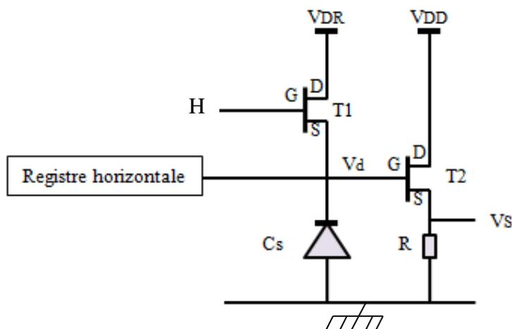
Figure 93: Convertisseur charge-tension.
