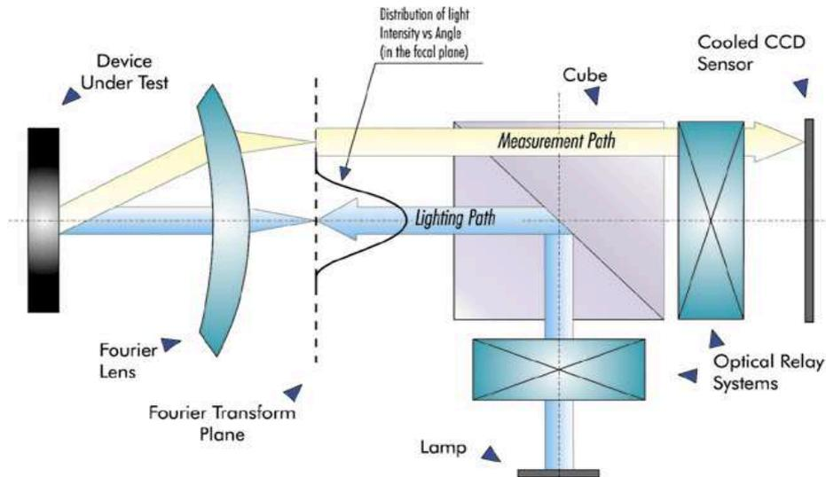
Figure 19 : Schéma de principe de l'EZ contrast [44]
