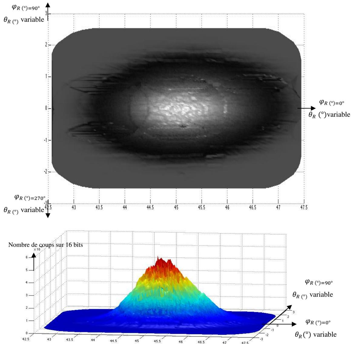
Figure 85 : Pic spéculaire recombinaé à partir de 9 clichés.
