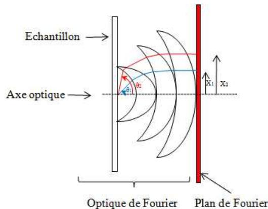
Figure 20 : Un exemple d'optique de Fourier.
