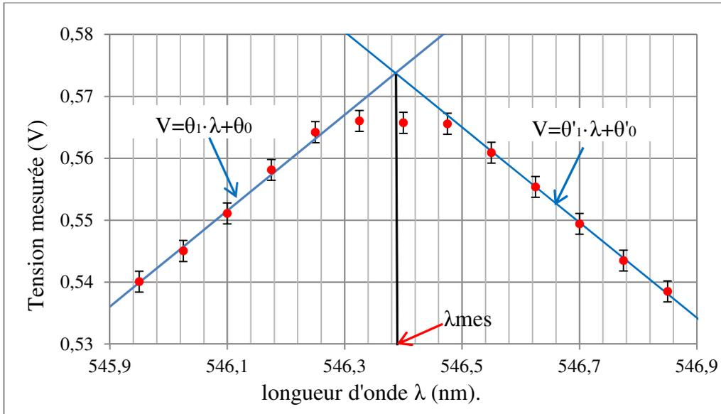
Figure 47 : Mesure de la raie à  $\lambda_{théo} = 546,074\text{nm}$ .
