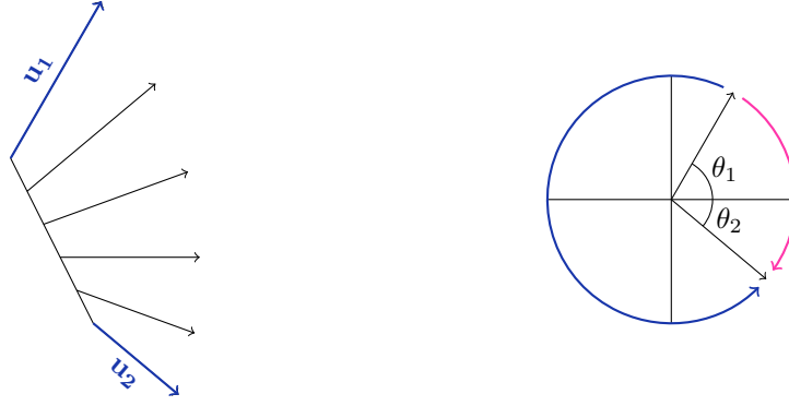
FIGURE 2.24 – Exemple d’interpolation linéaire entre deux vecteurs \mathbf{u}_1 et \mathbf{u}_2 en prenant le chemin le plus court entre les angles \theta_1 et \theta_2 .
