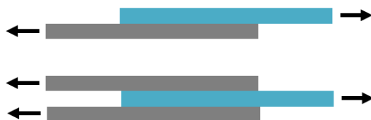
Figure I- 14 : Essais de cisaillement a) à simple recouvrement b) à double recouvrement
