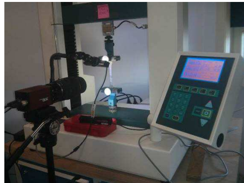
Figure A2- 2 : Dispositif expérimental de traction Tinius Olsen MIOKS du laboratoire du SIMaP
