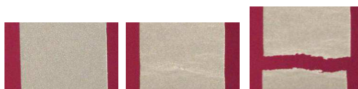
Figure A2- 4 : Photos décrivant le scénario de rupture d'une éprouvette au cours d'un essai de traction
