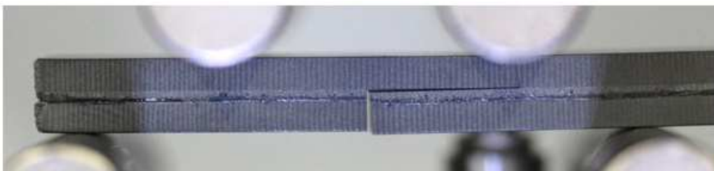
Figure IV- 3 : Fissuration asymétrique au cours d'un essai de flexion 4 points
