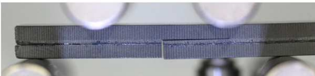
Figure IV- 3 : Fissuration asymétrique au cours d'un essai de flexion 4 points
