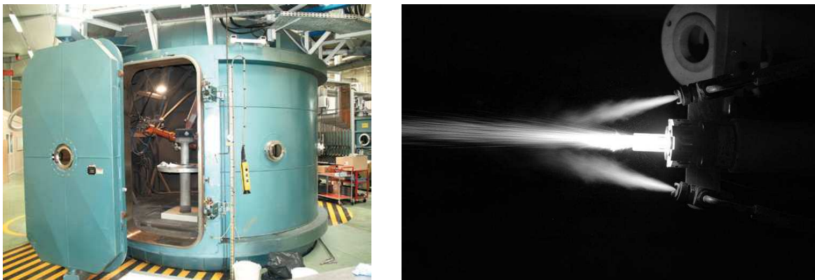
Figure II- 9 : Cabine de projection thermique (à gauche) et torche plasma (à droite) du CEA Le Ripault [CEA12]
