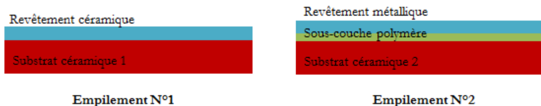
Figure 0- 2 : Schéma des empilements étudiés
