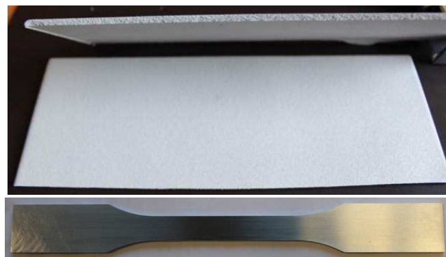
Figure II-11 : Plaques autoportées d'épaisseur 2,5 mm en aluminium plasma et éprouvette de traction « haltère »
