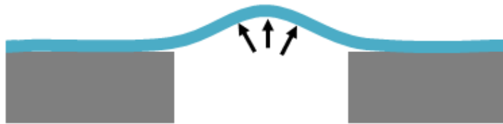
Figure I- 26 : Essai de gonflement-décollement
