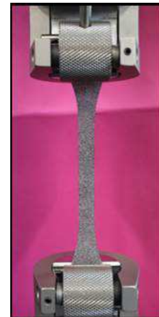
Figure II- 8 : Comportement mécanique en traction du polysulfone chargé de 80 μm d'épaisseur et dispositif CEA
