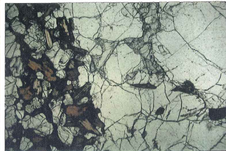
Photo 6 (L.N. : x 25): enclave composite type Ib (dunite) - filon de clinopyroxénite à biotite (type III)
