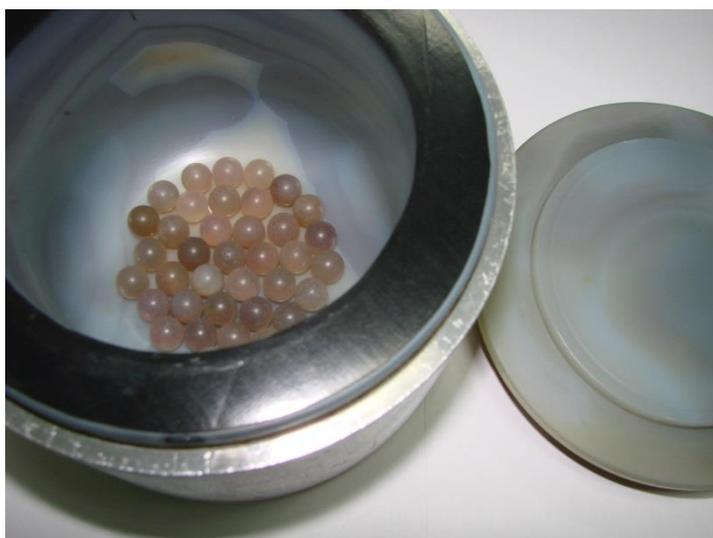
**Figure AI.1 : Broyeur à billes en agate du LGP2**
