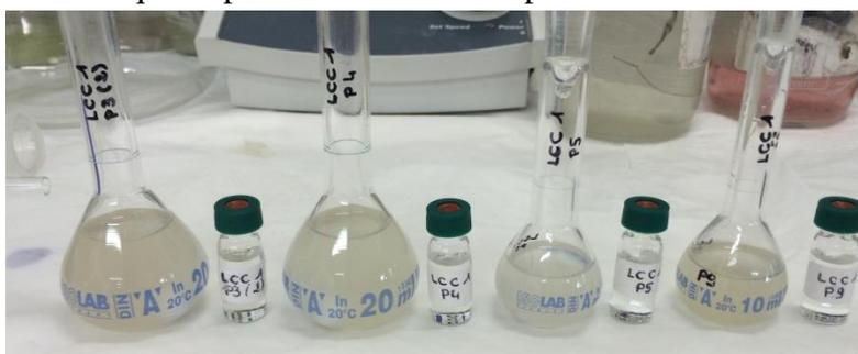
Figure 4.20 : Dissolution des LCC1 de pâtes dans le DMAc-LiCl avant filtration (dans les fioles) et après (dans les vials)
