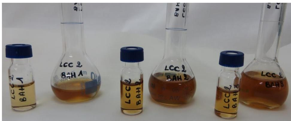
Figure AII.2 : Echantillons de LCC2 de bois intact (en haut) et préhydrolysé (en bas) dans un mélange DMAc-LiCl avant et après filtration
