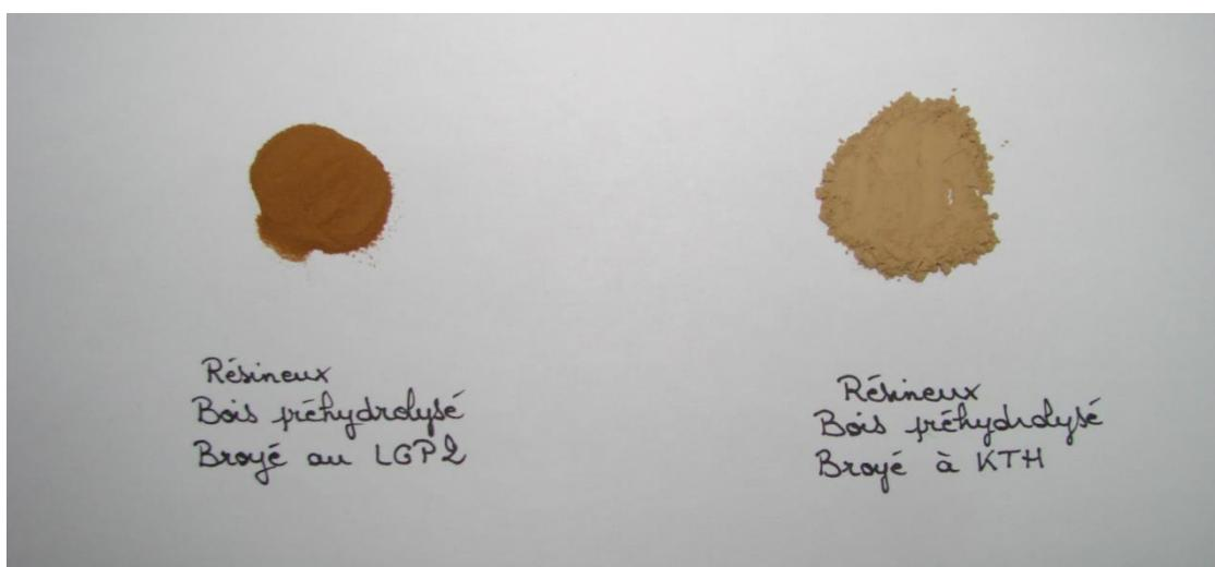
**Figure AI.3 : Comparaison de couleur du bois préhydrolysé broyé au LGP2 et à KTH**
