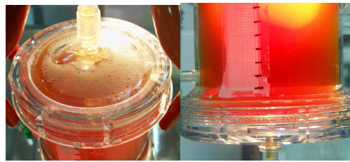
Figure 99: Manipulation de fluidisation inverse. A gauche : Présence de mousse à l'entrée du bioréacteur. A droite: Difficultés de visualisation de la hauteur du lit fluidisé.
