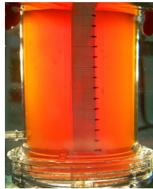
Figure 98: Manipulation de fluidisation inverse à débit nul (Le lit est tassé en haut du bioréacteur)
