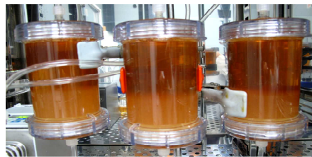
Figure 104: Expériences de fluidisation dans du plasma de bœuf à un débit de 25ml/min
