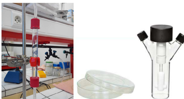
Figure 59: De gauche à droite: Bioréacteur de taille réduite (Medicolab), Boîte de Petri en verre de 6cm de diamètre (Duran) et Spinner de 50ml (Wheaton)
