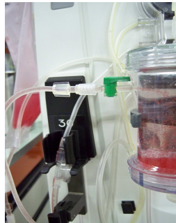
Figure 136: Introduction des billes par un robinet
