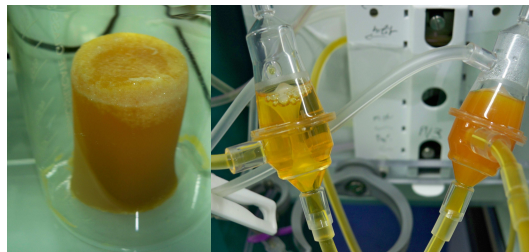
Figure 179: A gauche: Démoulage de la cartouche IE250. A droite : Pièges à bulles en amont et en aval de la cartouche IE250 (le piège à bulle en aval contient du plasma qui totalement figé).
