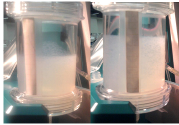
Figure 85: Fluidisation à 100ml/min au sein d'une cartouche MARS. A gauche: Sans répartiteur. A droite: Avec répartiteur.
