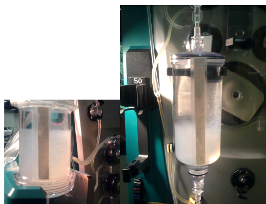
Figure 82: A gauche : Fluidisation au sein de la cartouche MARS. A droite : Fluidisation au sein de la cartouche ENSO (Débit = 100ml/min)
