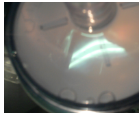
Figure 83 : Des bulles d'air se forment près du joint de la cartouche ENSO signe d'une perte d'étanchéité
