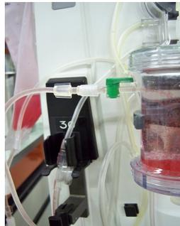
**Figure 136: Introduction des billes par un robinet**
