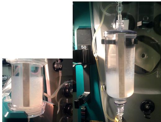
**Figure 82: A gauche : Fluidisation au sein de la cartouche MARS. A droite : Fluidisation au sein de la cartouche ENSO (Débit = 100ml/min)**
