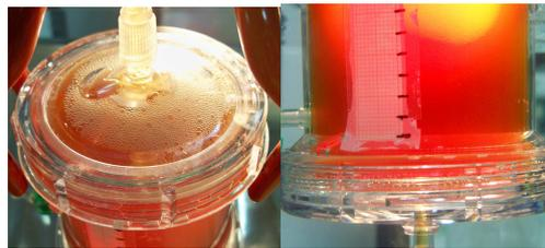
**Figure 99: Manipulation de fluidisation inverse. A gauche : Présence de mousse à l'entrée du bioréacteur. A droite: Difficultés de visualisation de la hauteur du lit fluidisé.**
