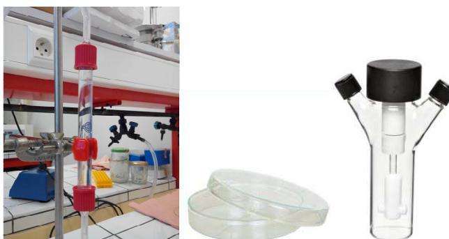
**Figure 59: De gauche à droite: Bioréacteur de taille réduite (Medicolab), Boîte de Petri en verre de 6cm de diamètre (Duran) et Spinner de 50ml (Wheaton)**
