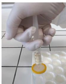
**Figure 50: Stérilisation manuelle de l'alginate par filtration**
