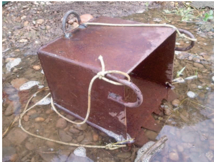
Figure 14 : Boîte à griffes utilisée lors des prélèvements de sédiment sur les frayères.
