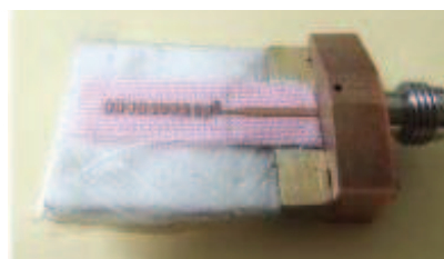
Figure II.2 - Antenne Yagi-Uda sur substrat textile pour les communications on-body à 60 GHz [16].
