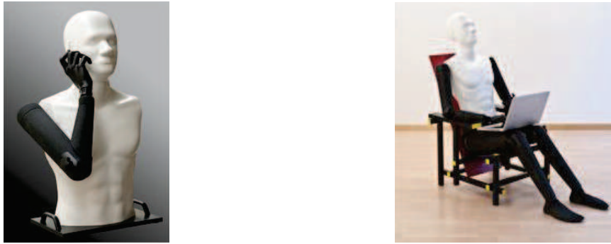
Figure I.10 - Exemple de contenant pour fantômes liquide de type TORSO-X-V5.x pour les études dosimétriques de 300 MHz à 6 GHz [32].
