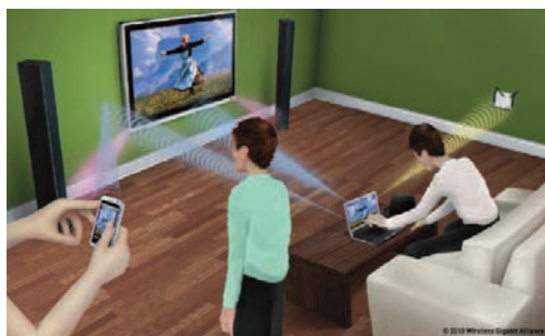
Figure I.3 - Exemple de réseau indoor à 60 GHz [5].
