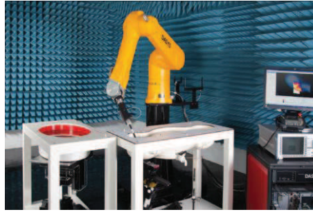
Figure I.13 - Scanner électromagnétique avec bras robotisé DASY52 SAR (Speag, Schmid & Partner Engineering AG, Zurich, Switzerland) [32].
