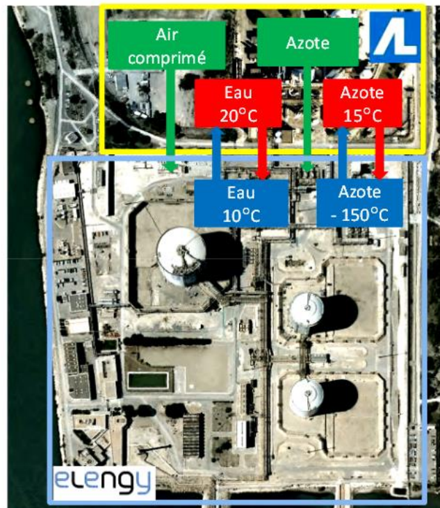
Synergies (valorisation de frigories) sur le terminal méthanier de Fos Tonkin entre les entreprises Elengy et Air Liquide (source : Bavuz et Carrese, 2013)
