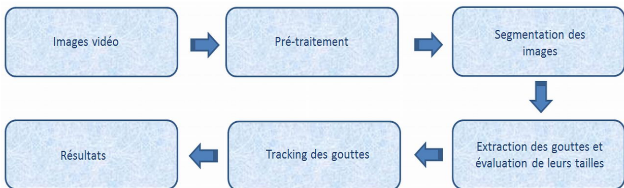
Figure 3. Flow chart de l'algorithme d'analyse des images pour la caractérisation des gouttelettes
