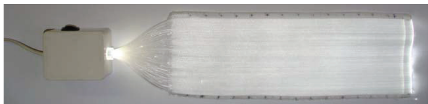
Figure 1.23 : sortie de la lumière homogène sur la longueur du textile pour le rayonnement visible
