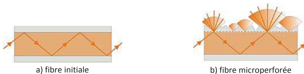
Figure 1.22 : schéma de la microperforation de la fibre optique 139
