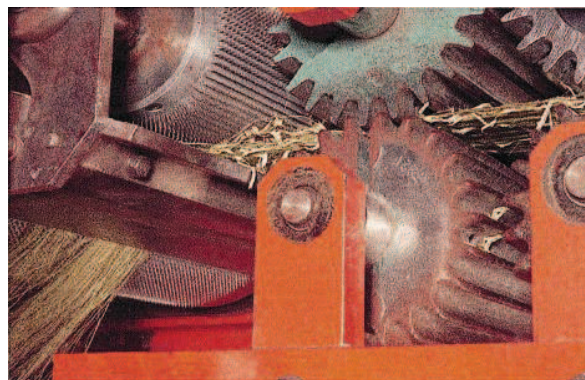
Figure 1-17 : Illustration du défibrage mécanique des tiges de chanvre
