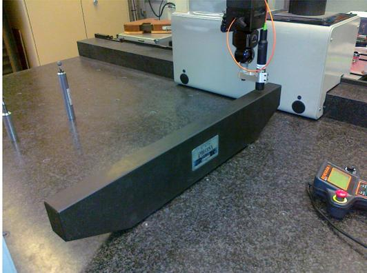
(a) Mesure de la rectitude verticale de l'axe Y.
