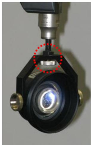
**Figure 57** – Fixation de l’œil de chat à l’extrémité de la cinématique.
