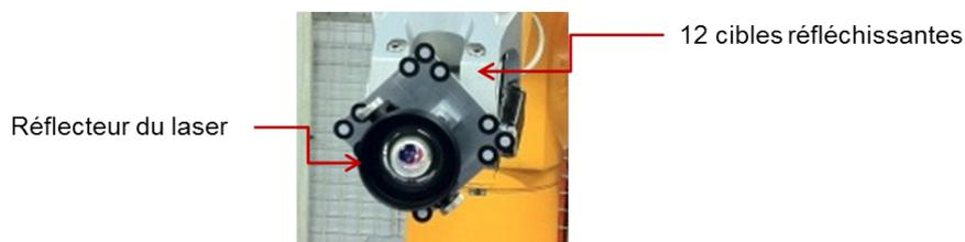
**Figure 95** – Positionnement des cibles et du réflecteur.
