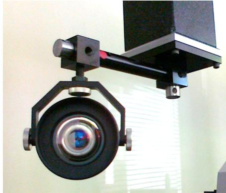
**Figure 75** – Décalage du réflecteur par assemblage d'éléments modulaires.
