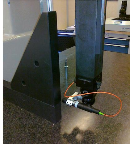
(b) Mesure à l'aide d'une équerre pour caractériser le coulisseau.
