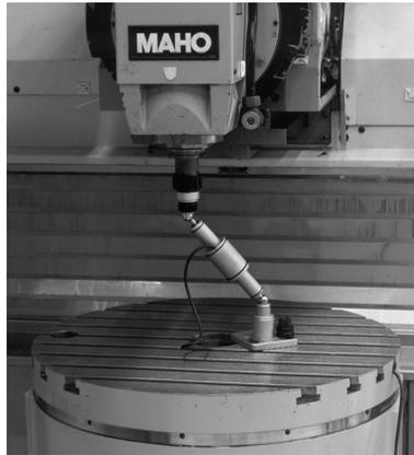
**Figure 28** – Etalonnage d'une MOCN à l'aide d'un ball-bar. Une extrémité est solidaire de la table tandis que l'autre est solidaire de la broche.
