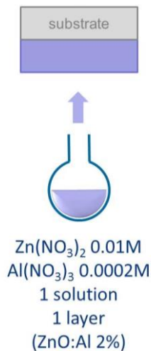
Figure 99 : Procédure d’injection d’une solution aqueuse de nitrates de zinc et d’aluminium (ou autre élément dopant).
